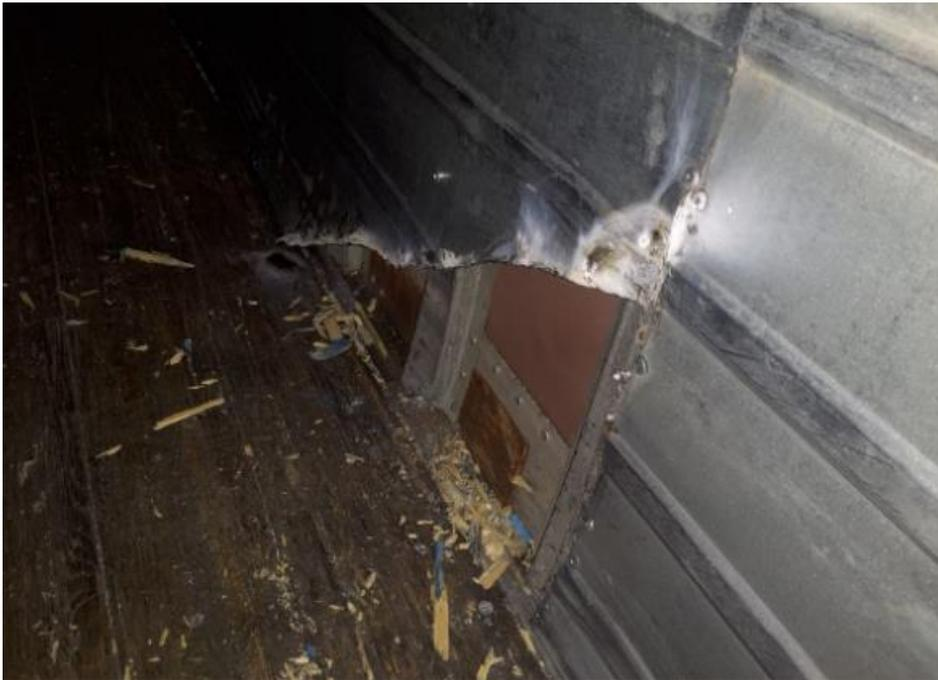
Figura 12. Pared con láminas sueltas.
