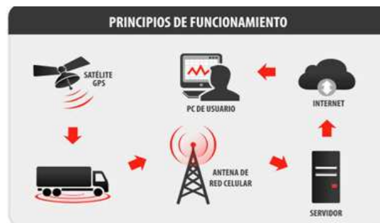
Figura 2.1.1 Principio de funcionamiento de rastreo satelital.
