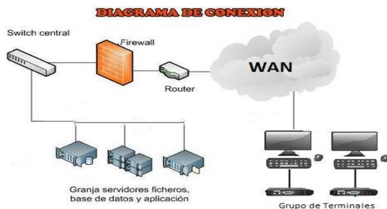
Figura 3.3.1 Diagrama de conexión terminales tontas
