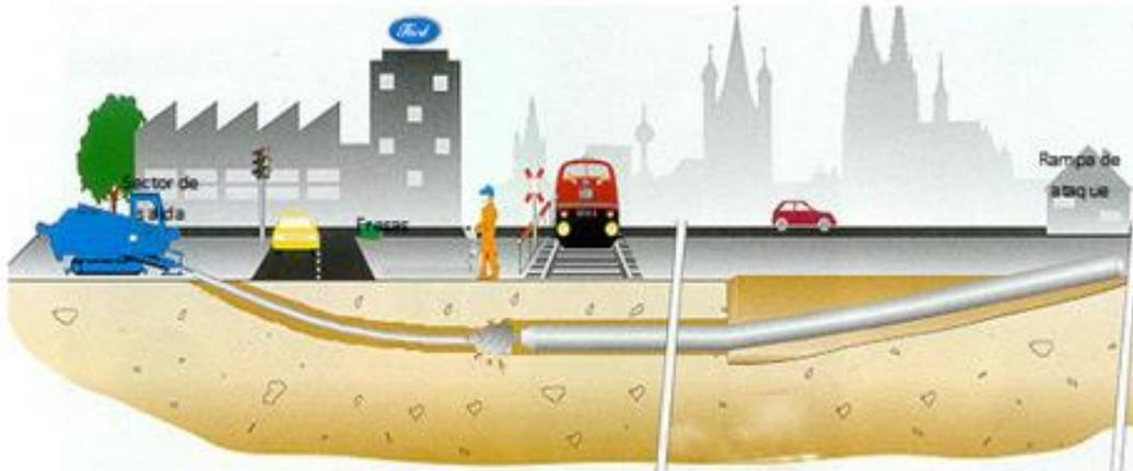
Figura V.1. Esquema general de la técnica de Perforación Horizontal Direccional. Cortesía de IACMEX/TECSA 2014.
