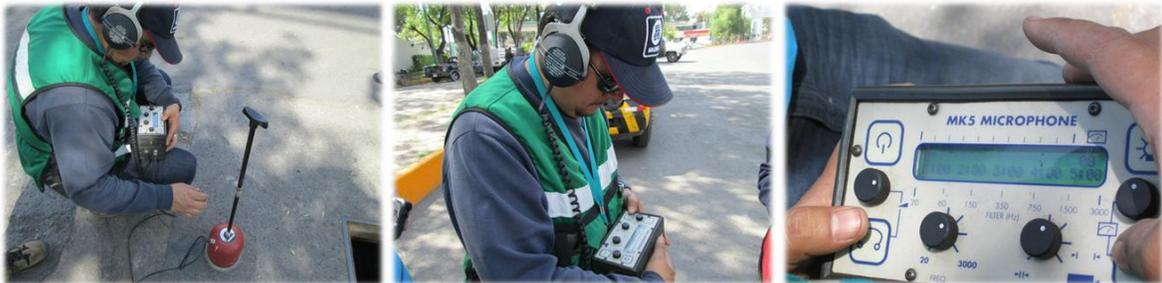
Figura IV.3. Localización de Interferencias durante los Recorridos de Campo con la Dependencias que Integran el CUS. Cortesía de IACMEX/TECSA 2014.
