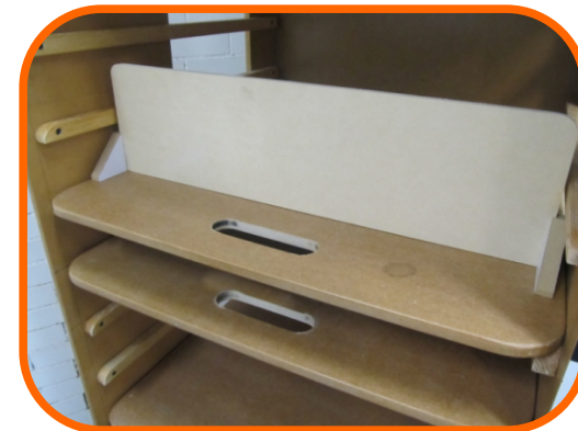
Fig 16. Topes para determinar profundidad
