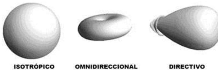
Figura 2.2 Patrones de radiación isotrópico, omnidireccional y directivo.
