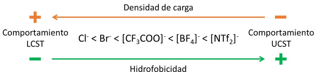
**Figura 15.** Comportamiento termomórfico esperado de una mezcla de IL con agua o disolventes próticos en función del anión que compone al líquido iónico.<sup>25</sup>
