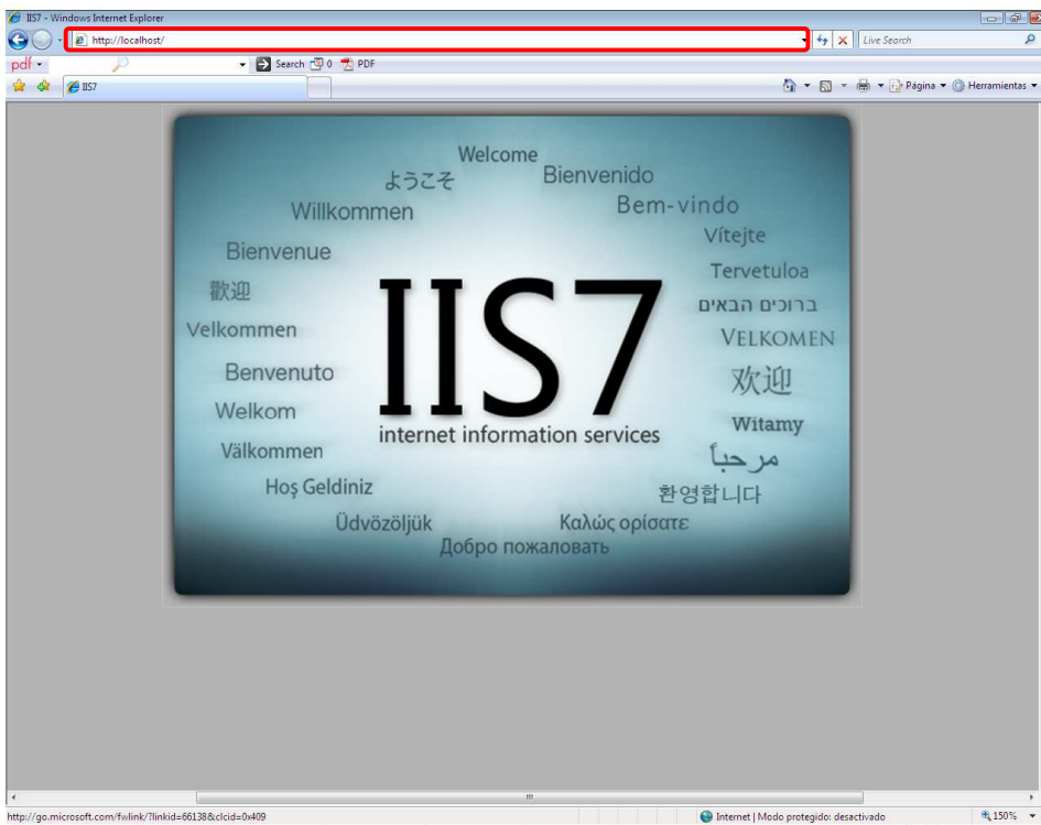
Figura 4.4-1 Validando la instalación del IIS
