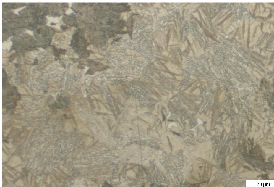
Figura 4.23: Imagen de microscopía óptica a 500X de acero 1212 enfriado a 0.1°C/s en ensayo CCT. Se observa fase perlítica, martensítica, bainítica y ferrítica.
