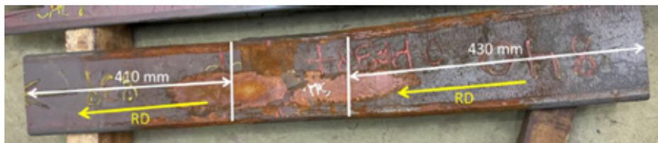
Figura 3.1: Barra de acero laminada. El extremo izquierdo es el acero 1212 y el derecho el acero 2212.
