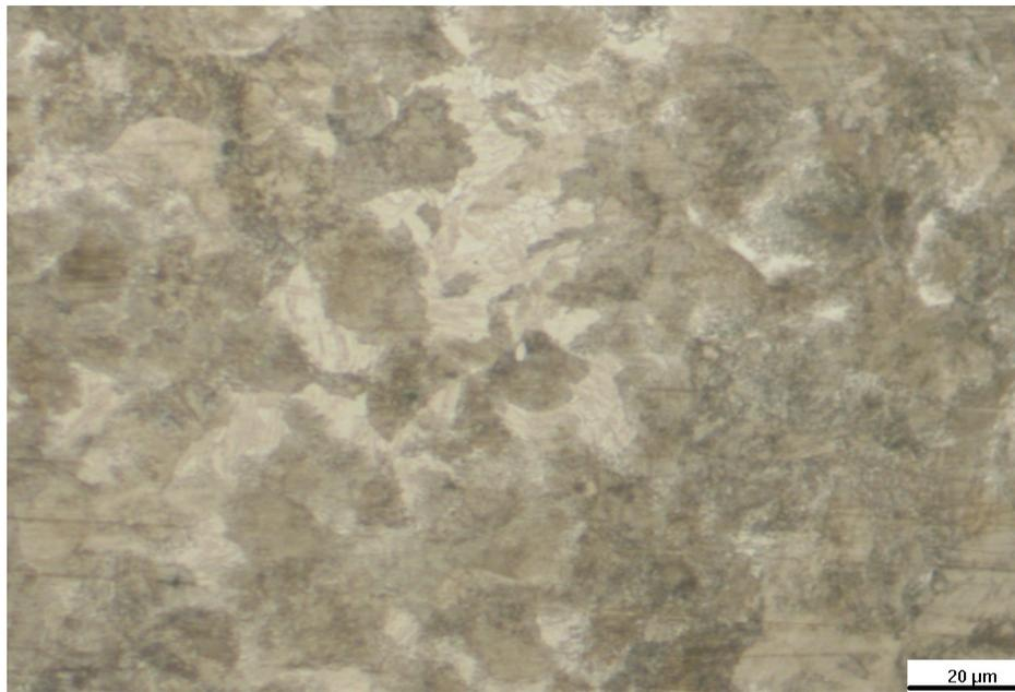
Figura 4.24: Imagen de microscopía óptica a 500X de acero 2212 enfriado a  $0.1^{\circ}\text{C}/\text{s}$  en ensayo CCT. Se observa bainita y perlita.
