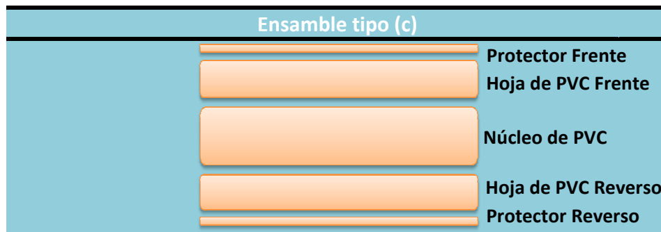
Imagen 2.3 - Tres hojas (hoja frente + núcleo + hoja reverso) con protección frente-reverso
