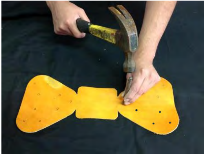
Imagen 80. Perforado de lomo con sacabocados (3/16")
