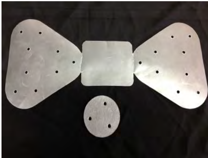
Imagen 76. Plantillas hechas en lámina de acero calibre 17
