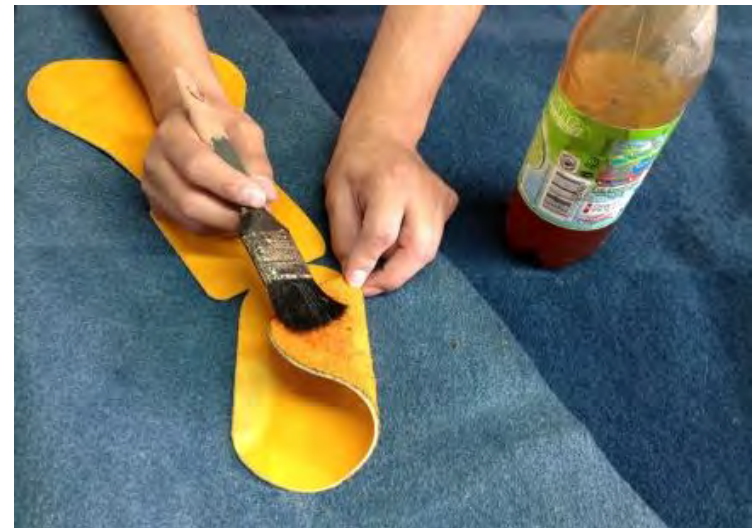
Imagen 79. Pegado y posterior secado de alfombra y vaqueta en piezas de lomo
