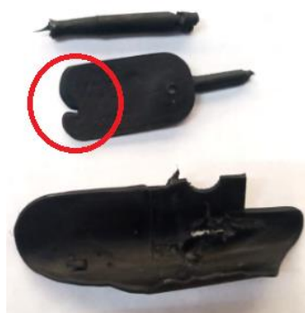
Figura 74. Piezas de inyección al 20% de volumen de inyección.
