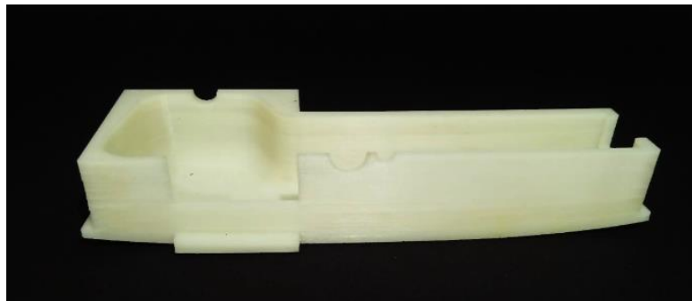
Figura 63. Pieza con alabeo, fabricada con PC-ABS.
