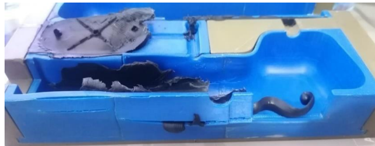
Figura 86. Fractura en el lateral en la placa de cavidades.
