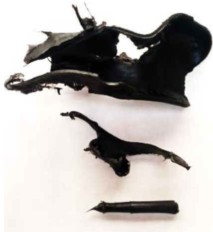
Figura 79. Piezas de inyección resultantes del tercer experimento.
