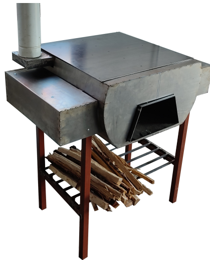
Figura 2.18. Prototipo real a escala real de la estufa de tipo plancha y portátil de flujo lateral cruzado.
