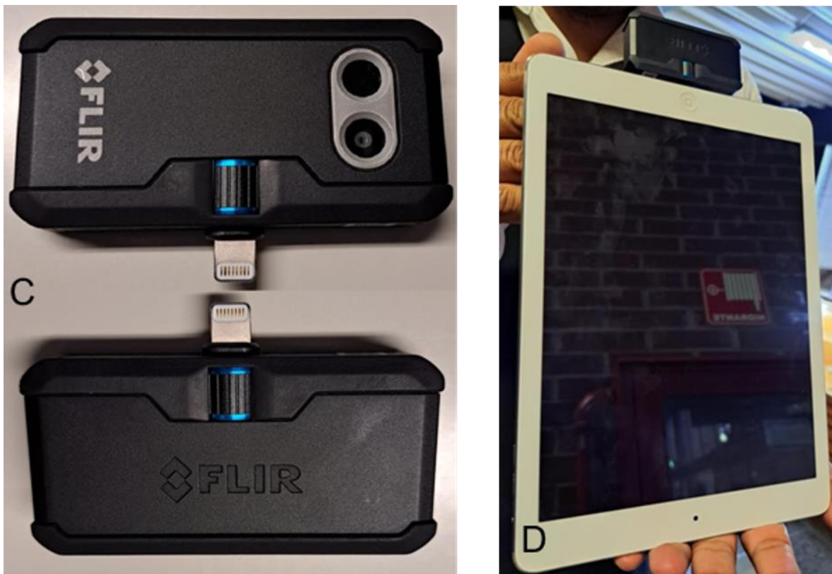
Imagen 3: A) Cámara Termográfica Flir One Pro® de ambas caras. D) Tablet y cámara Flir One Pro® conectadas, de esta forma se utilizaba para tomar las fotografías.
