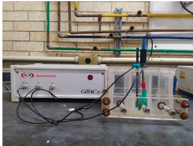
Figura 2.2 Arreglo de la celda y equipo Gill AC utilizado en las mediciones electroquímicas.
