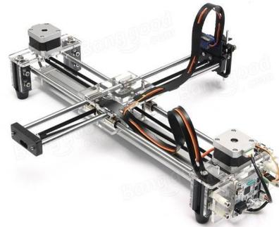
Figura 2.2: Máquina CNC de dos ejes, imagen obtenida de internet [18].
