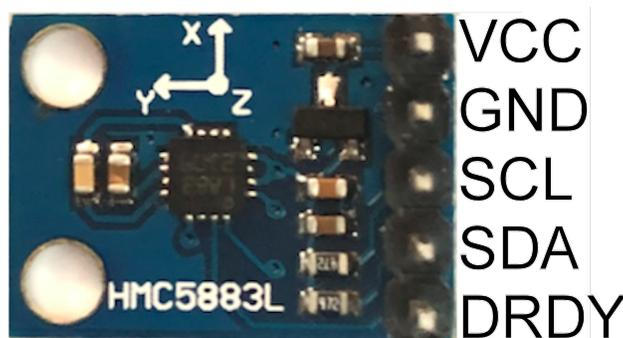
Figura 1.12: Fotografía del sensor HMC5883L empleado en este proyecto.
