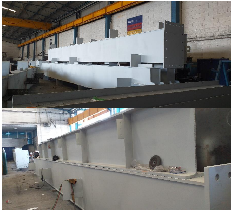
Fig. 12 (Aplicación de Primer)
