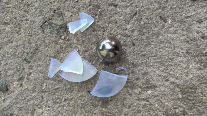
Figura 20 Lente esférica con fotocurado después de la prueba de Drop Ball Test.
