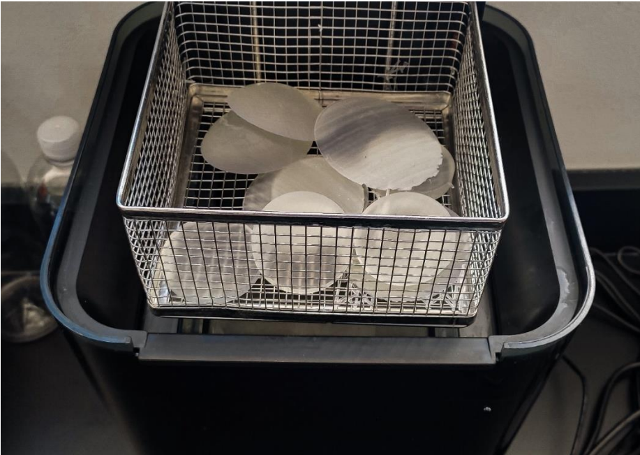
Figura 18 Lentes esféricas diseñadas con impresión 3D en cabina de Formwash para lavado con alcohol isopropílico.
