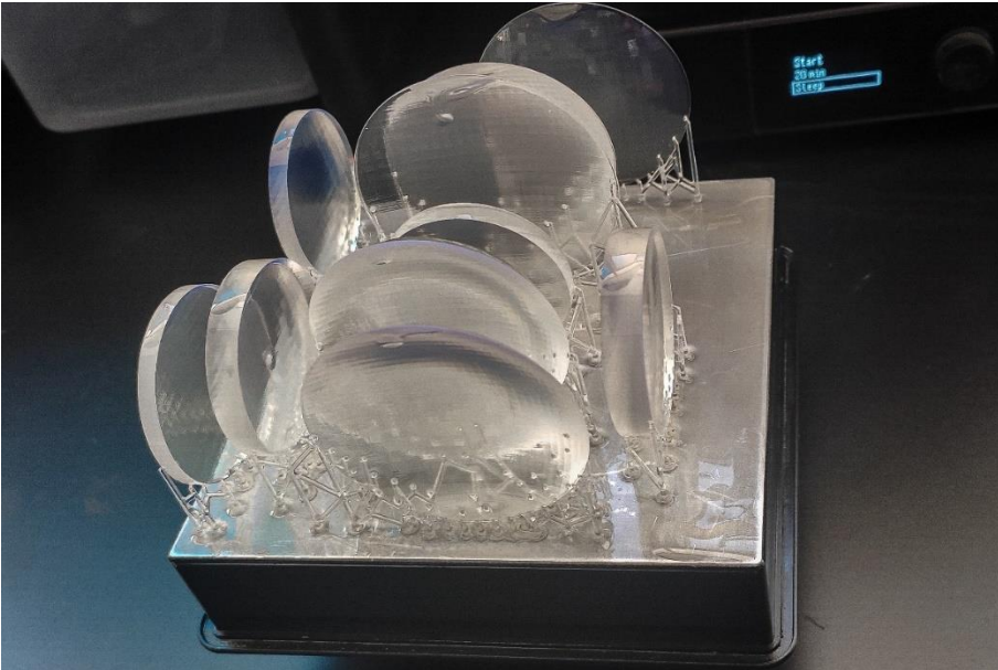
Figura 16 Lentes esféricas diseñadas en 3D recién impresas y con estructura de soporte.
