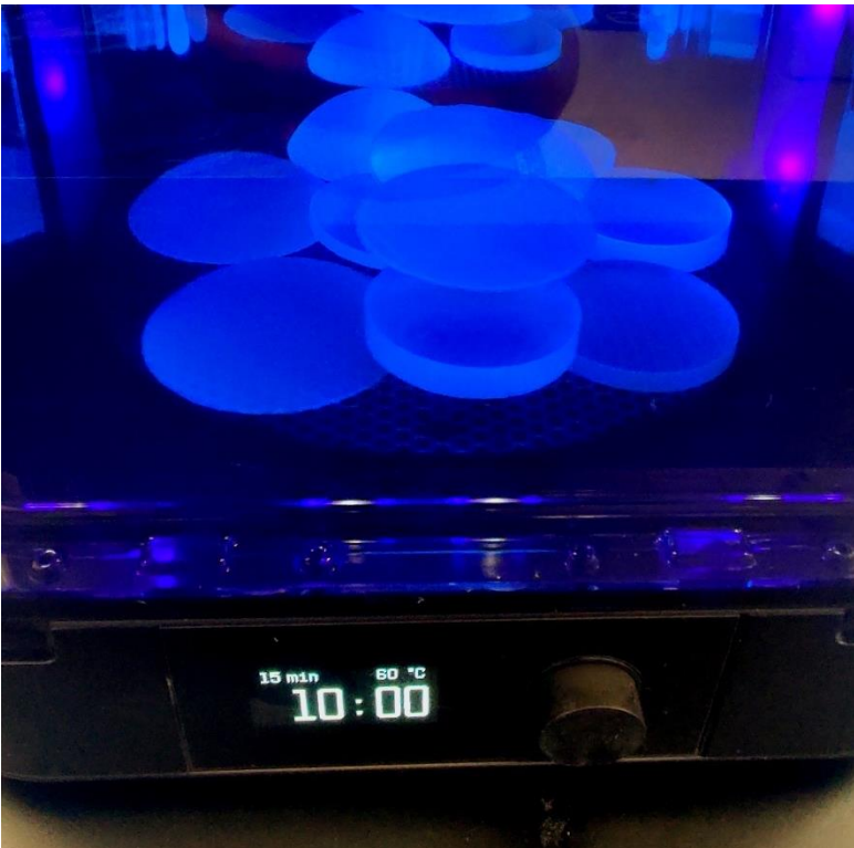
Figura 19 Lentes esféricas diseñadas en impresión 3D en proceso de fotocurado.
