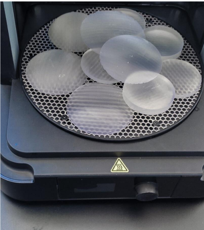
Figura 17 Lentes esféricas diseñadas con impresión 3D sin fotocurar.
