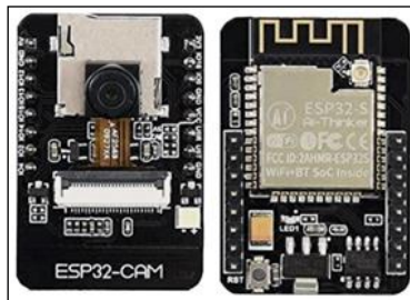
Figura 2.4. Tarjeta de desarrollo ESP32-CAM genérica.
