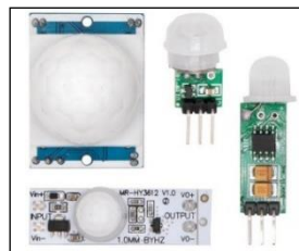
Figura 2.19. Módulos con sensor PIR.
