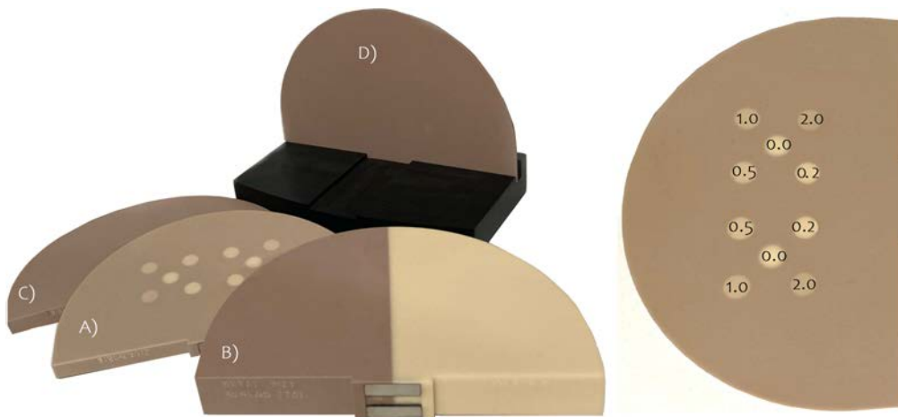
Figura 2.6: Maniquí CIRS. La imagen de la izquierda muestra el conjunto de placas que contiene el maniquí. La imagen derecha muestra la distribución de los depósitos con sus respectivas concentraciones.
