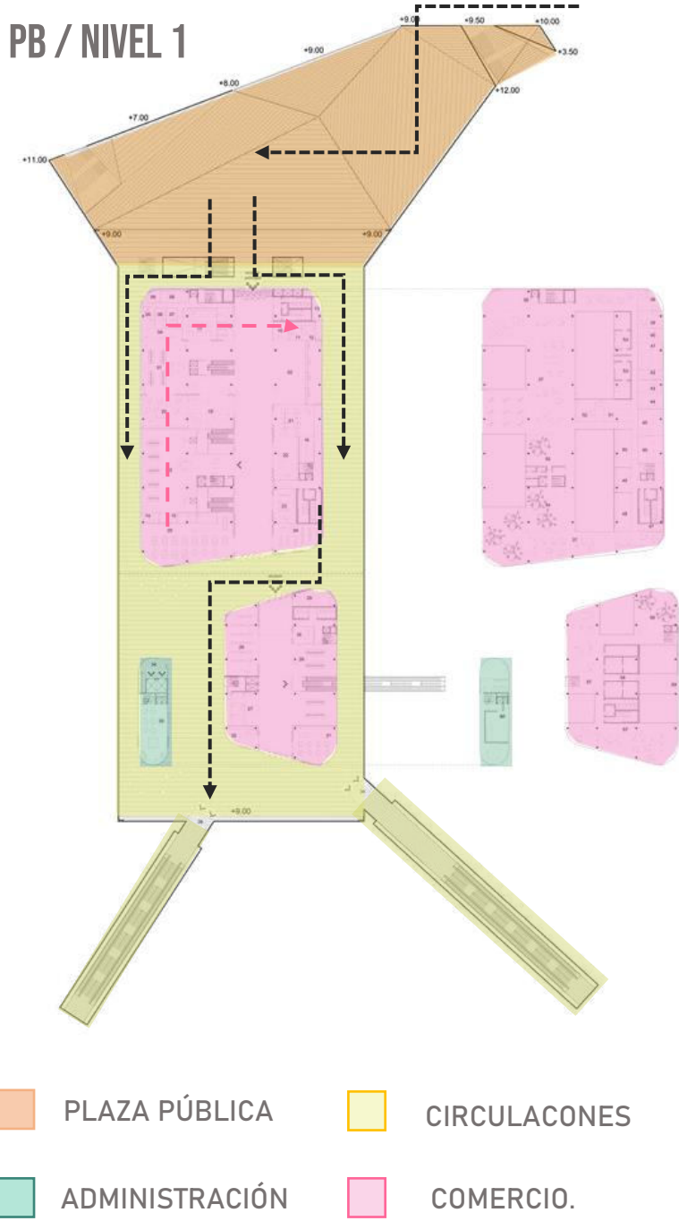
Gráfico 34. Plantas arquitectónicas y zonificación del proyecto Nueva Intermodal Santiago de Compostela. Fuente: Herreros Arquitectos.
