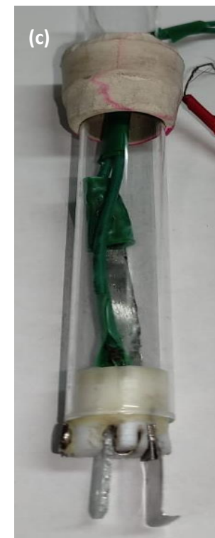
Anexo 27. a) Espectro de absorción de ITO reutilizados antes de emplearse en otros experimentos b) Dispositivo porta placas de ITO para medidas de espectrometría UV-Vis y c) Porta electrodos con separación estable entre electrodos.
