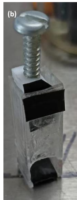
Anexo 27. a) Espectro de absorción de ITO reutilizados antes de emplearse en otros experimentos b) Dispositivo porta placas de ITO para medidas de espectrometría UV-Vis y c) Porta electrodos con separación estable entre electrodos.
