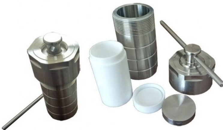
Figura 4.5: Reactor de síntesis solvotermal de acero inoxidable
