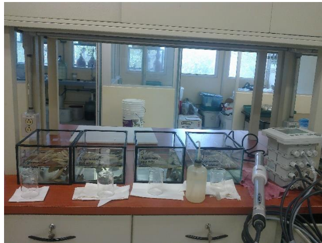
Figura 8. Prueba de lixiviación, peceras con hojas de mangle en diferentes tipos de agua.
