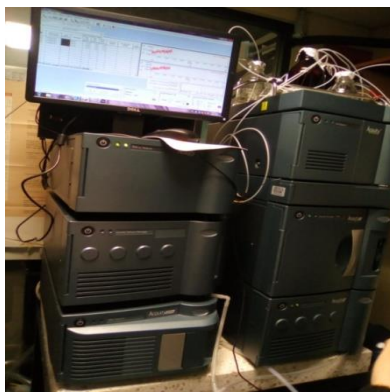
Figura 7. Cromatógrafo de líquidos de alta resolución clase H, marca Waters con módulos de muestras, bomba, detector UV y masas.
