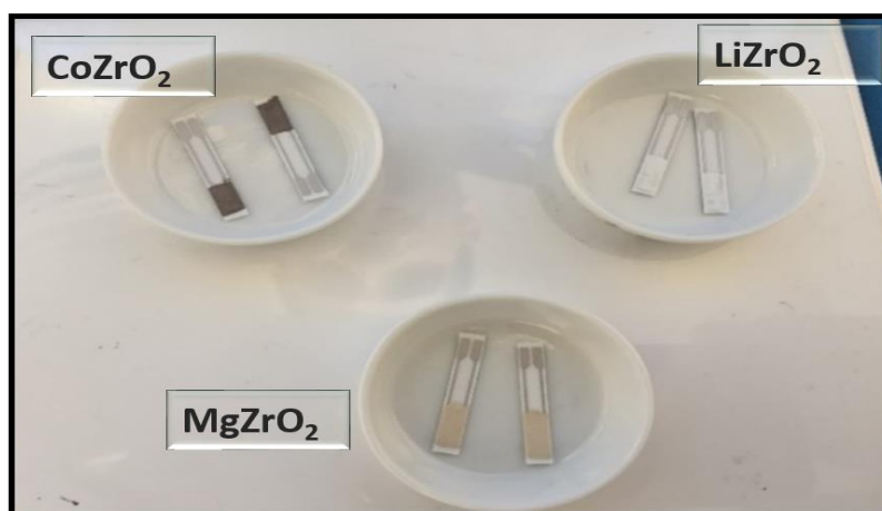
Figura 41. Sensores listos para la prueba de detección de CO 2
