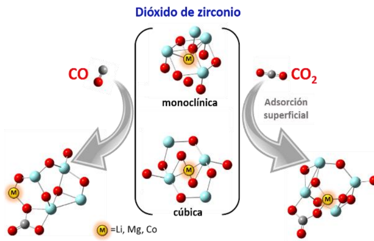
Figura 71. Absorción de monóxido y dióxido de carbono por LiZrO 2 , MgZrO 2 y CoZrO 2
