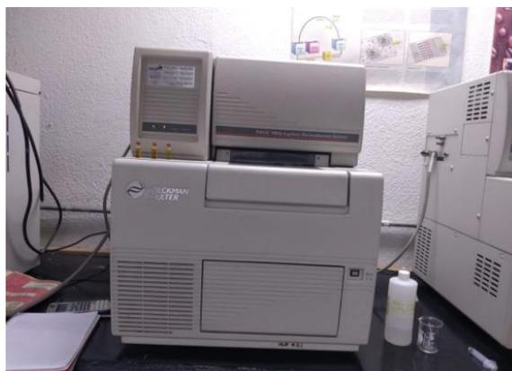
Figura 18. Equipo de electroforesis capilar
