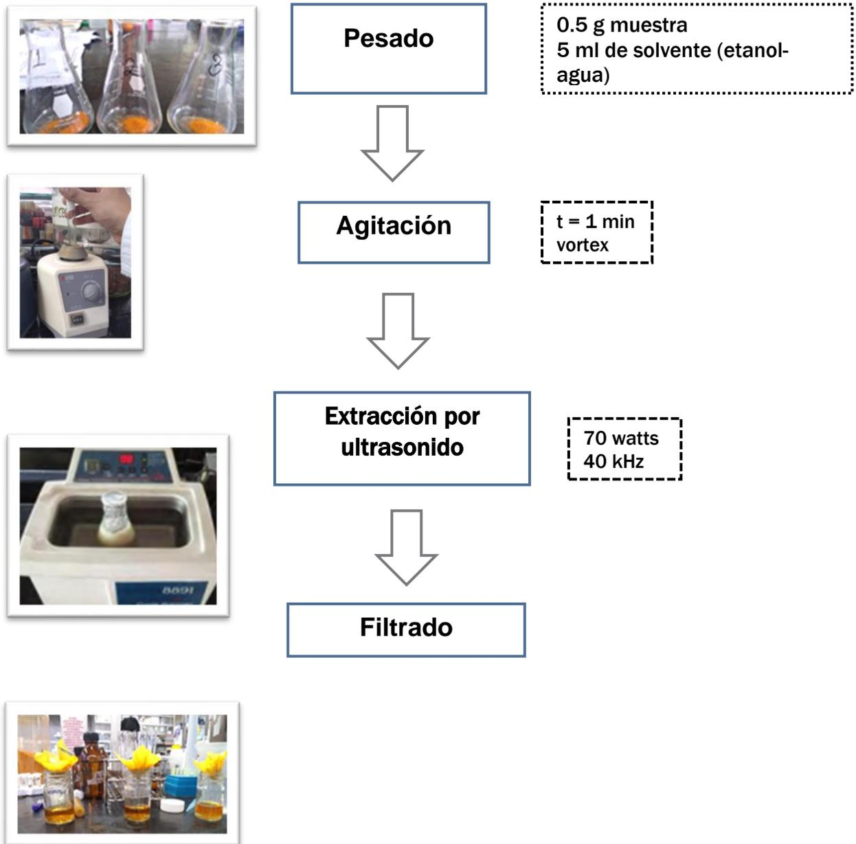
Figura 16. Diagrama de proceso de extracción asistida por ultrasonido de compuestos bioactivos de la flor de cempasúchil.
