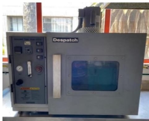
Figura 3.5 Horno Rotatorio de Película Delgada del Laboratorio de Vías Terrestres del Instituto de Ingeniería UNAM
