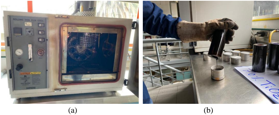
Figura 3.7 (a) Interior del RTFO con los 8 vasos (b) Obtención de residuo de cemento asfáltico
