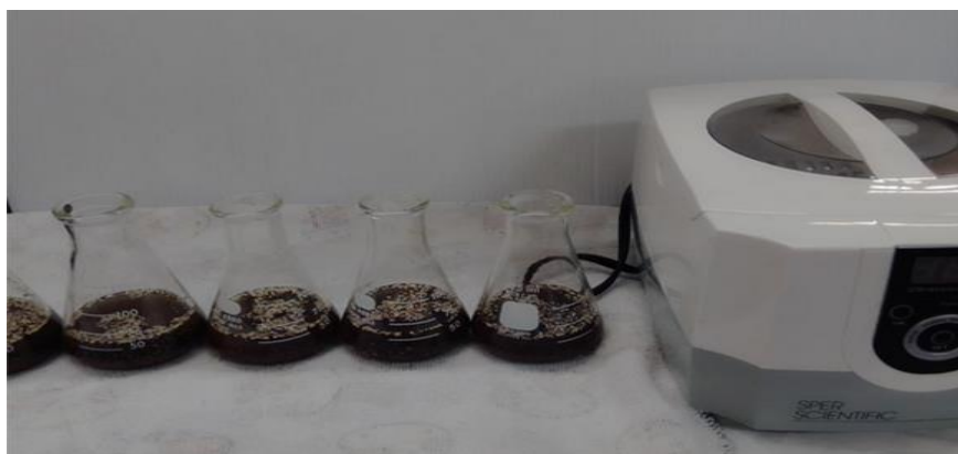
Figura 24. Extracción con disolvente asistida por ultrasonido.
