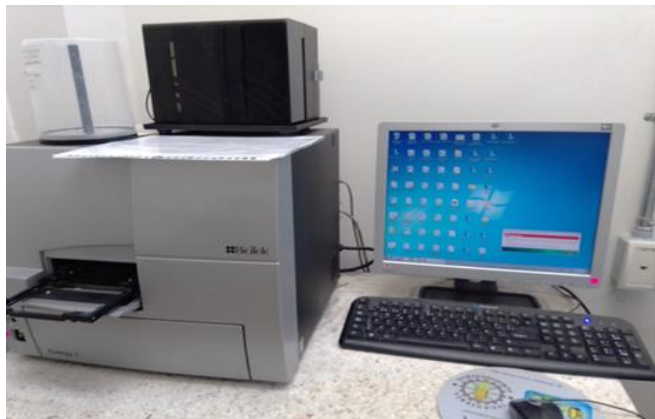
Figura 25. Lector de micro placas con dispensadores automáticos.
