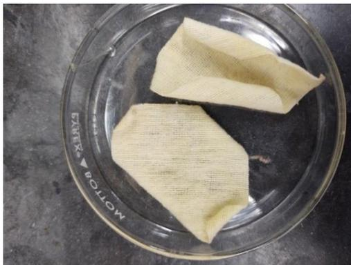
Figura 4. 2 Muestras de tela impregnadas con TiO<sub>2</sub>-AgNPs
