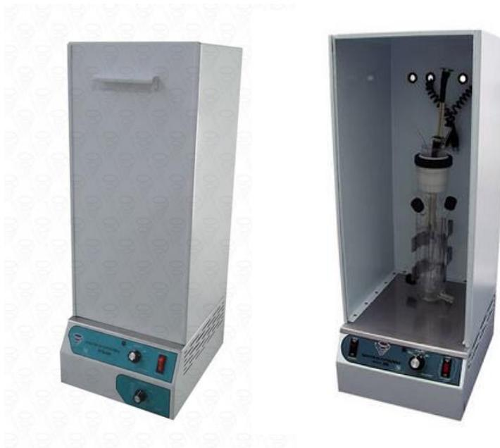
Figura 5. 16 Fotorreactor utilizado para realizar las pruebas de fotocatalisis de las muestras
