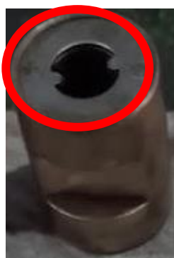
Figura 38. Guía y reten de balines. (Hernández, J. Fotografía tomada en el taller de mantenimiento del tren ligero, el día 22 de abril de 2022, Huipulco CDMX).
