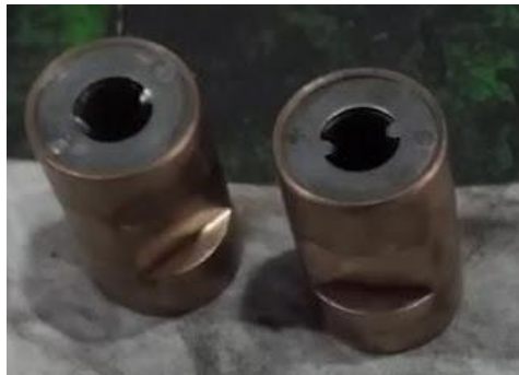
Figura 37. Seguidores de tornillo de paso contrario. (Hernández, J. Fotografía tomada en el taller de mantenimiento del tren ligero, el día 22 de abril de 2022, Huipulco CDMX).
