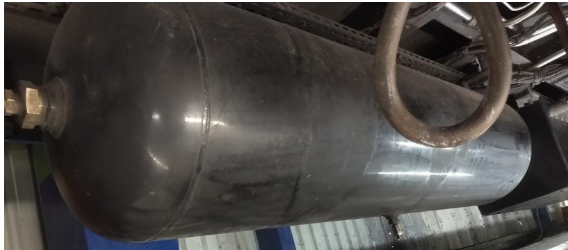
Figura 50. Tanque principal de 250 litros. (Hernández, J. Fotografía tomada en el taller de mantenimiento del tren ligero, el día 22 de agosto de 2022, Huipulco CDMX).
