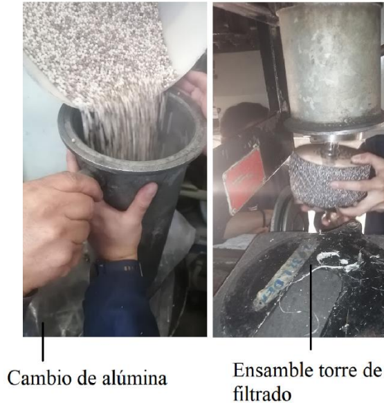
Figura 73. Mantenimiento a secador de aire regenerativo. (Hernández, J. Fotografía tomada en el taller de mantenimiento del tren ligero, el día 25 de agosto de 2022, Huipulco CDMX).
