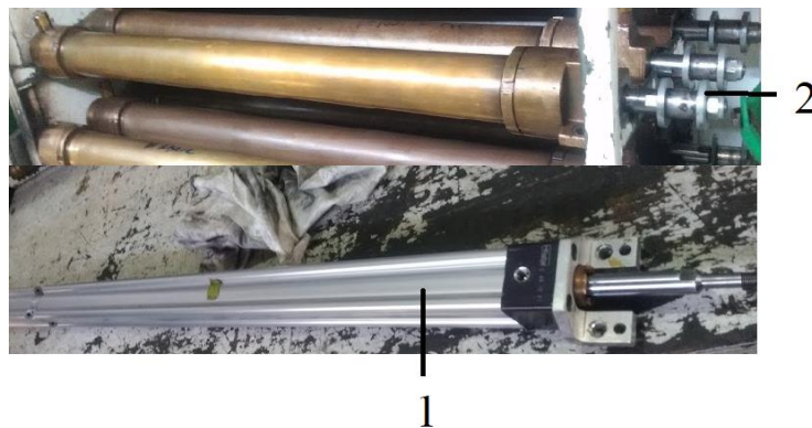
Figura 26. Modelos de cilindros neumáticos. (Hernández, J. Fotografías tomadas en el taller de mantenimiento del tren ligero, el día 31 de mayo de 2022, Huipulco CDMX).
