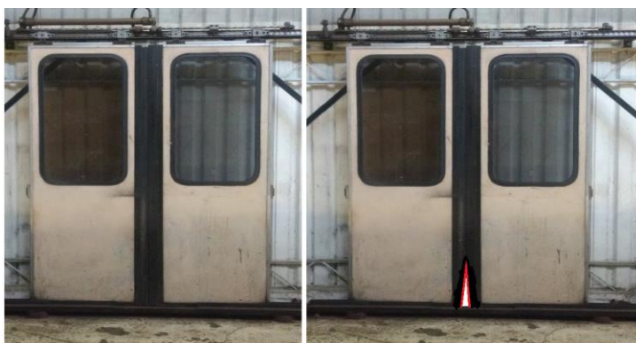
Figura 41. Regulación de excéntricas. (Hernández, J. Fotografía tomada en el taller de mantenimiento del tren ligero, el día 7 de junio de 2022, Huipulco CDMX).
