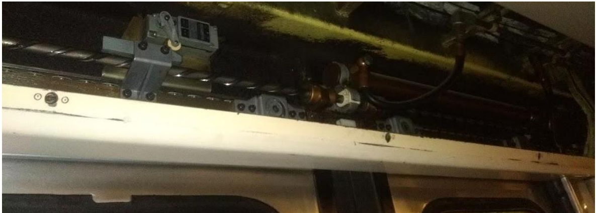
Figura 27. Mecanismo de puertas montado. (Hernández, J. Fotografía tomada en el taller de mantenimiento del tren ligero, el día 7 de junio de 2022, Huipulco CDMX).
