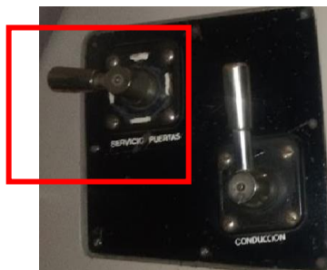
Figura 63. Conmutador de puertas. (Hernández, J. Fotografía tomada en el taller de mantenimiento del tren ligero, el día 30 de junio de 2022, Huipulco CDMX).
