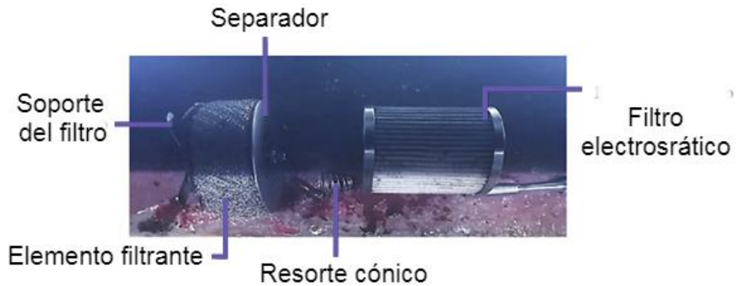
Figura 71. Elementos de torre de filtrado. (Hernández, J. Fotografía tomada en el taller de mantenimiento del tren ligero, el día 25 de agosto de 2022, Huipulco CDMX).
