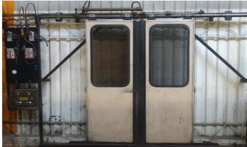
Figura 33. Banco de pruebas de mecanismo de puertas. (Hernández, J. Fotografía tomada en el taller de mantenimiento del tren ligero, el día 7 de junio de 2022, Huipulco CDMX).
