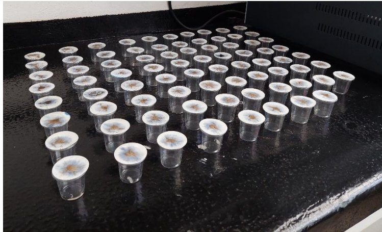
Fig. 13. Papel filtro con la muestra de fosfatos finalizada, sobre los vasos de gelatina.
