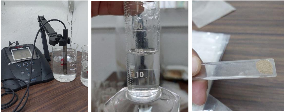
Fig. 15. De izquierda a derecha: medición de pH en agua destilada de distintos garrafones, medición de los 20ml del agua destilada para las muestras, porción de la muestra en la cucharilla de acrílico.
