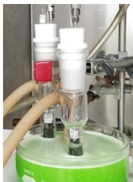
Figura 41. Celda de reacción dividida, con arreglo de tres electrodos, a 20 \text{ }^\circ\text{C} y atmósfera inerte.
