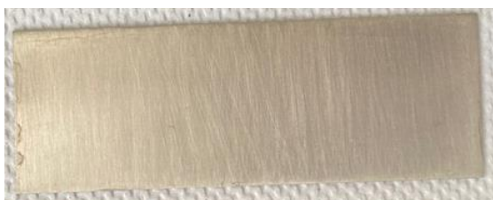
Figura 15. Sustrato de latón con recubrimiento de níquel.
