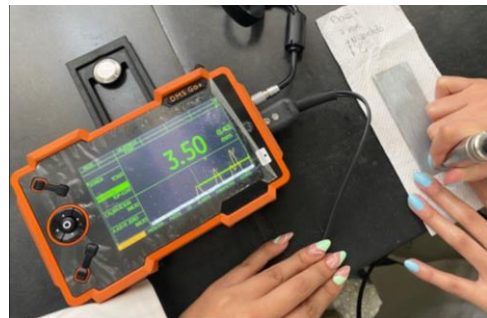
Figura 23. Medición del espesor de recubrimiento de cromo por inspección por ultrasonido DMS Go+ a los bloques patrón de latón.
