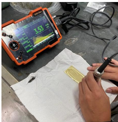
Figura 7. Medición de espesores con ultrasonido DMS Go+ en el sustrato de latón.
