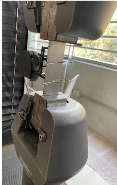
Figura 33. Ensayo de tensión, bloque sustrato sin recubrimiento.
