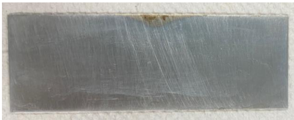
Figura 22. Bloque patrón de latón con recubrimiento de Ni-Cr.
