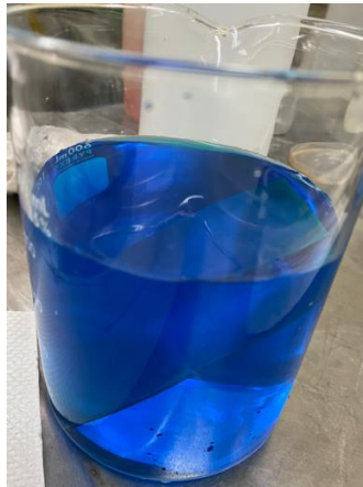
Figura 12. Inmersión de sustratos con recubrimiento de Ni en sulfato de cobre (CuSO 4 ) 1.18 M.
