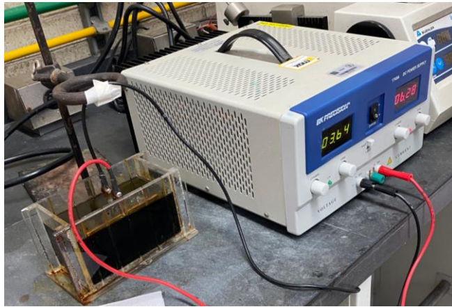
Figura 21. Montaje para los recubrimientos de Cr, fuente de poder, celda Hull de acrílico con ánodo de Cr y cátodo de latón.
