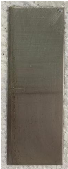
Figura 24. Bloque patrón de acero 316L con recubrimiento de Ni-Cr.
