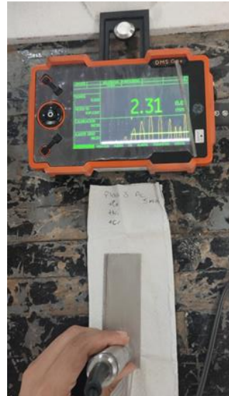
Figura 25. Medición del espesor de recubrimiento de cromo por inspección por ultrasonido DMS Go+ a los bloques patrón de acero 316L.
