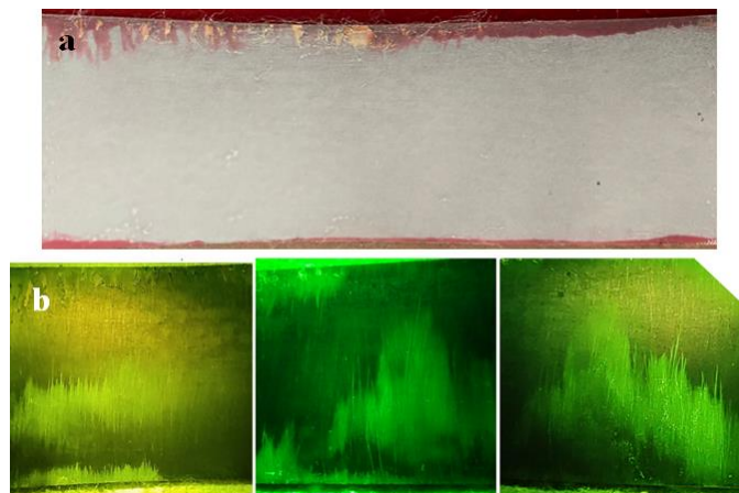
Figura 56. Bloque patrón 4 (7 min) con líquidos penetrantes nuevos, a) coloreados y, b) fluorescentes.
