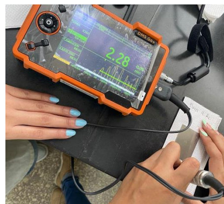
Figura 6. Medición de espesores con ultrasonido DMS Go+ en el sustrato de acero inoxidable 316L.
