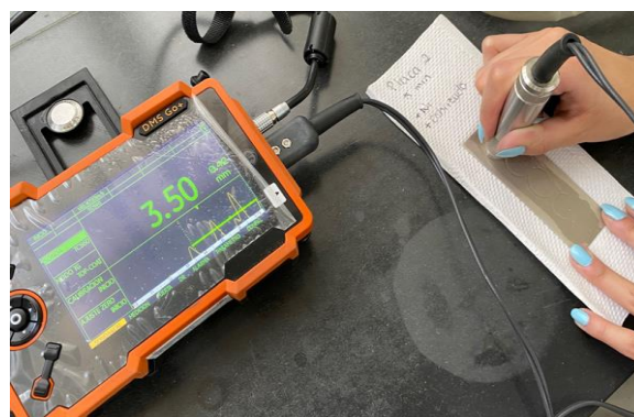
Figura 17. Medición del espesor de recubrimiento de níquel por inspección por ultrasonido DNS Go+ a los sustratos de latón.
