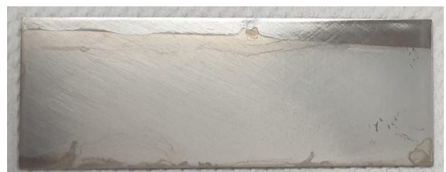
Figura 16. Sustrato de acero inoxidable con recubrimiento de níquel.
