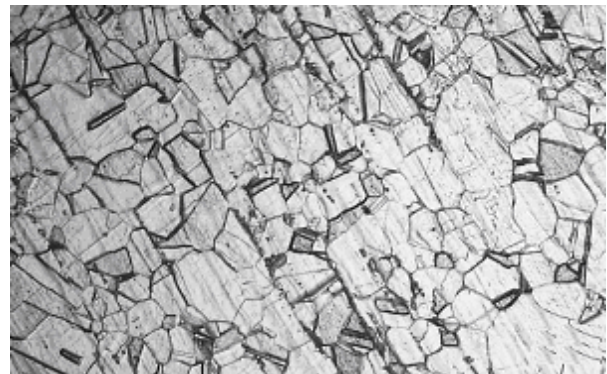
Figura 58. Microestructura reportada en la literatura de un acero 316L.[42]
