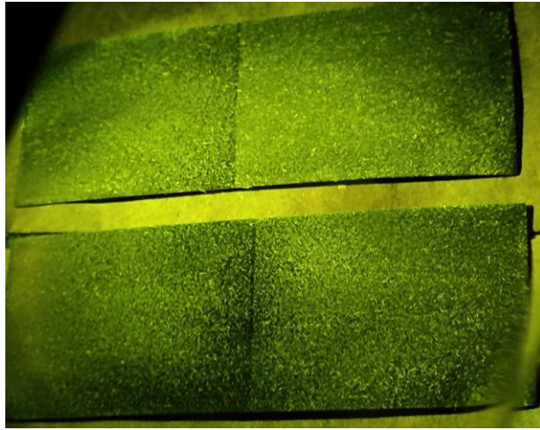
Figura 40. Resultado de la aplicación del líquido penetrante sobre placas con diferente rugosidad.
