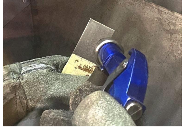
Figura 9. Sand-blasting sobre placa de acero 316L.
