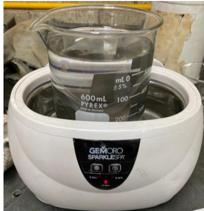
Figura 18. Cuba de baño ultrasónico para placas de aceros.
