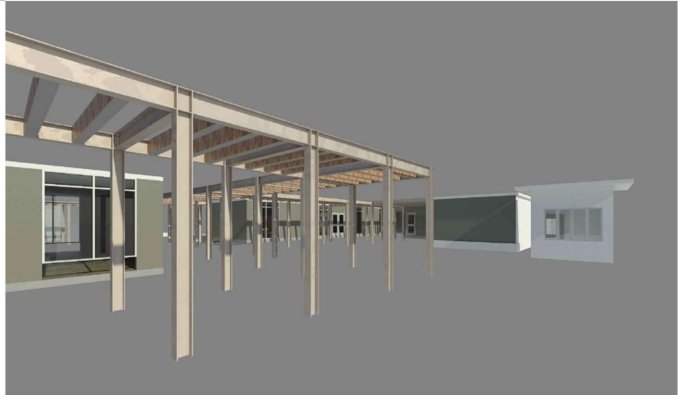
DETALLE VOLUMEN ESTRUCTURA PASO CUBIERTO (PERGOLADO)
