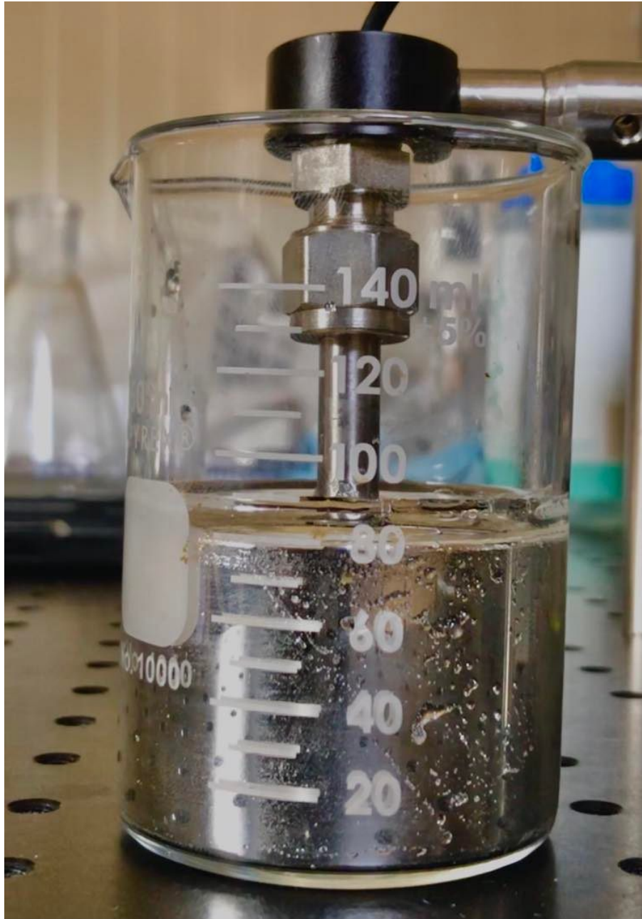
Figura A.1: Configuración para determinar la velocidad del sonido en GaInSn.
