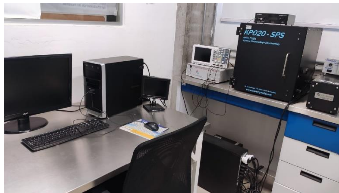
Figura 28. Sonda Kelvin marca KP Technology modelo KP020-SP.
