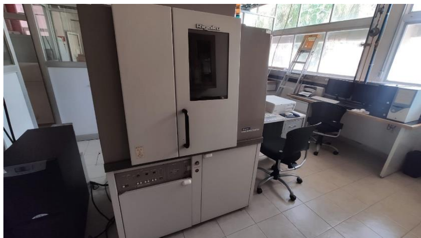
Figura 21. Difractómetro Rigaku, modelo D/MAX 2200.
