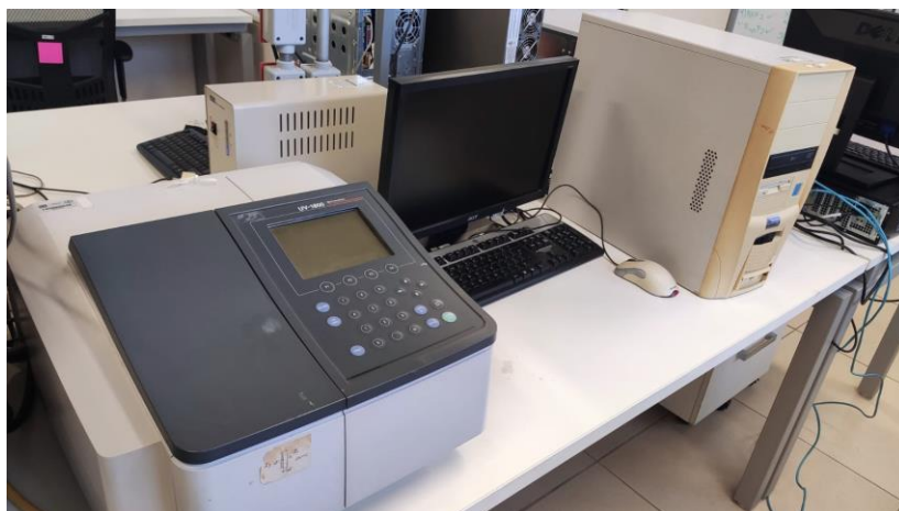
Figura 24. Espectrofotómetro UV-Vis Shimadzu modelo UV-1800.
