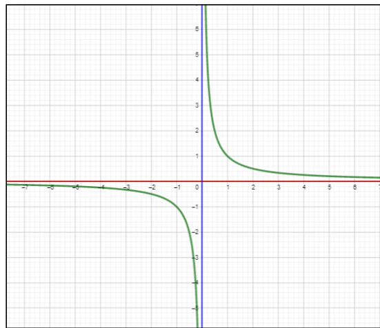
Figura 1-29 Se muestra que las asíntotas de la curva son los ejes coordenados.
