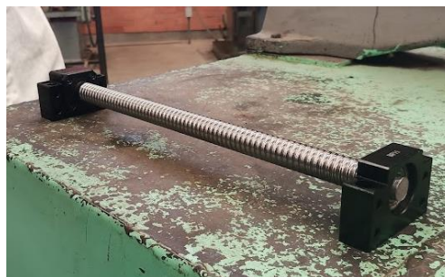
Ilustración 95. Husillo acoplado sobre los soportes.
