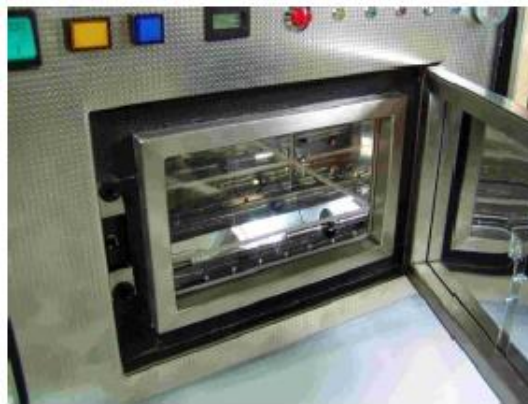
Ilustración 5. Cámara de tratamiento de alimentos que utiliza pulsos de luz.
