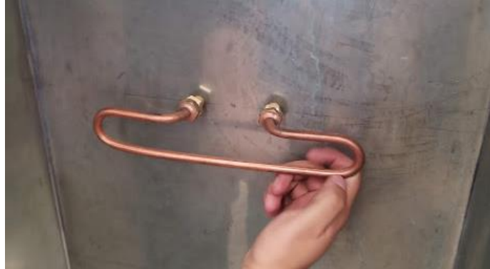
Ilustración 124. Perforación y colocación de resistencia.
