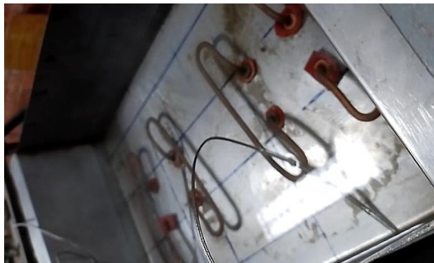
Ilustración 138. Prueba del sistema de calentamiento.
