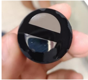
Ilustración 115. Estado final de encapsulado y preparación metalográfica.
