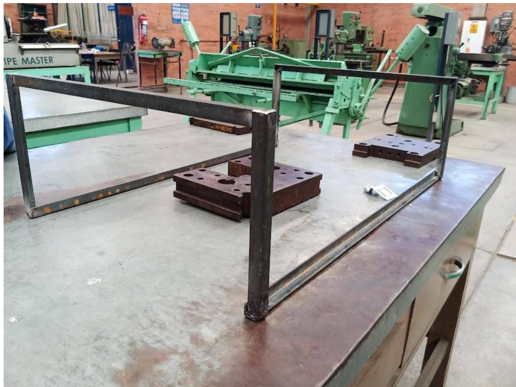
Ilustración 80. Estructura que soporta la charola.
