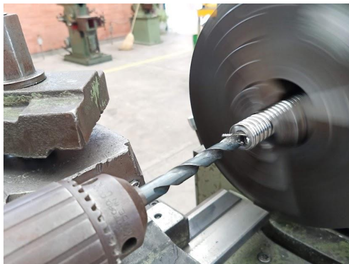
Ilustración 89. Perforación de diámetro mayor.
