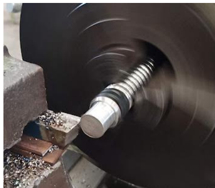
Ilustración 94. Desbaste del husillo en torno.
