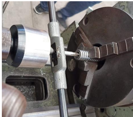
Ilustración 91. Proceso de rosca interna.
