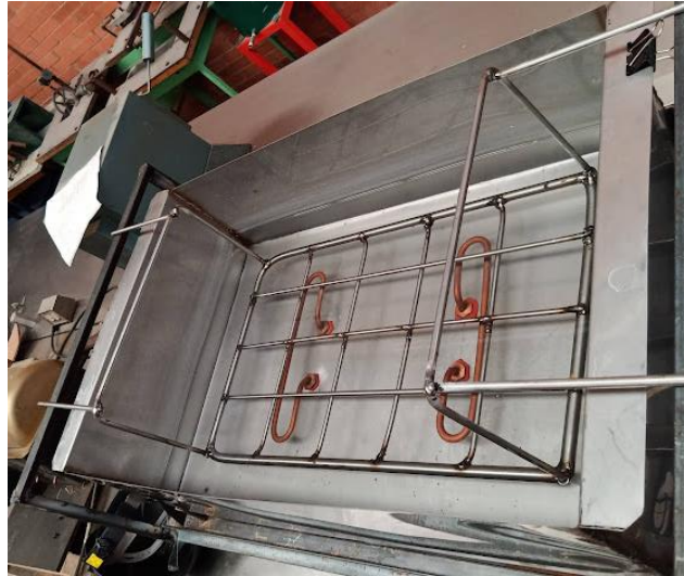
Ilustración 137. Prueba de calentamiento con dos resistencias.
