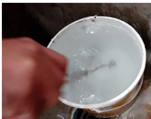
Ilustración 109. Enfriamiento brusco en agua.
