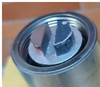
Ilustración 113. Piezas muestra de acero 1045.
