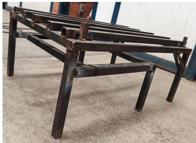
Ilustración 85. Base del sistema de elevación unida a la base de la máquina.
