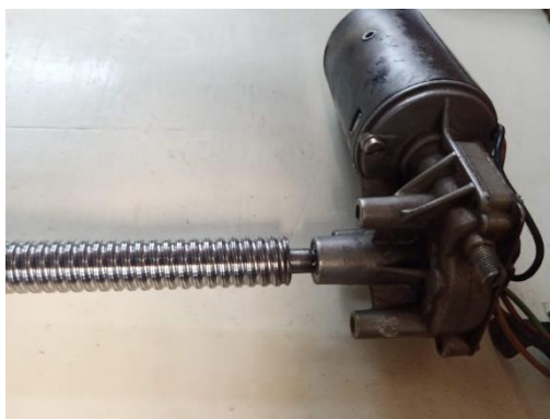
Ilustración 92. Ensamble de husillo al eje del motor.
