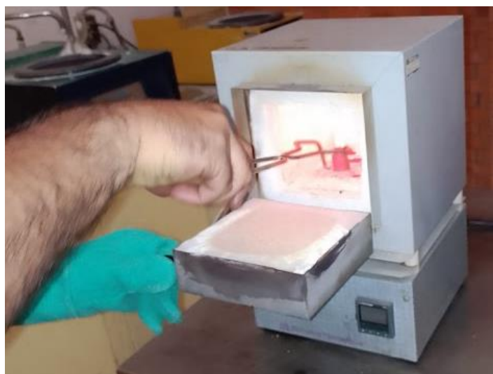
Ilustración 108. Proceso de temple.
