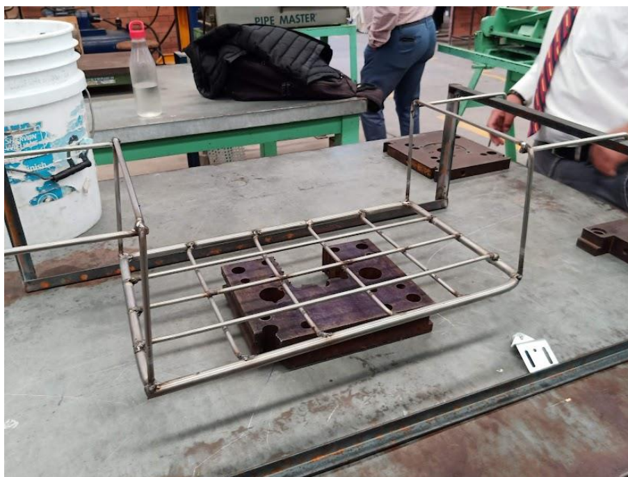
Ilustración 81. Soportes para que la charola repose sobre la estructura de elevación.
