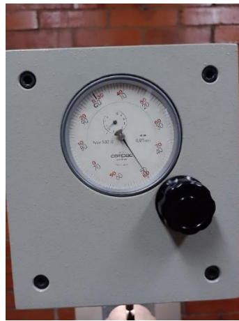
Ilustración 119. Prueba de dureza a muestra de acero 1045 tratada térmicamente.
