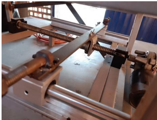
Ilustración 104. Unión de la tuerca de avance con las chumaceras de media luna.
