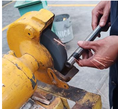
Ilustración 93. Desbaste del husillo en esmeril.
