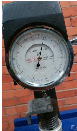
Ilustración 102. Prueba de dureza aplicada después de los tratamientos térmicos.
