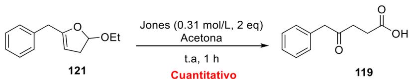
**Esquema 40.** Obtención del ácido **119** a partir del tratamiento de **121** con el reactivo de Jones.
