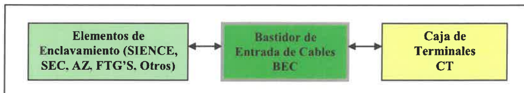
Fig. 5.16 Diagrama Bloques de la Interfaz de Enclavamiento - Equipo Exterior
