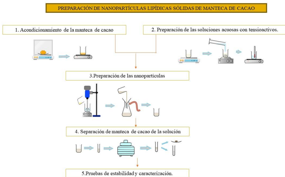
Figura 18. Proceso realizado en la preparación de nanopartículas lipídicas sólidas de manteca de cacao.
