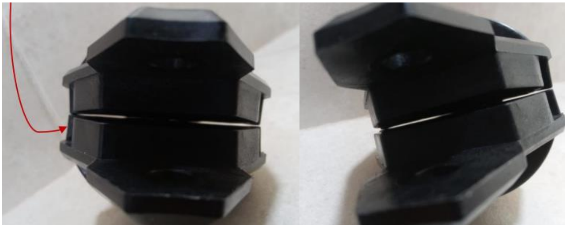
Figura 25 Deflexiones en la pieza vista frontal y oblicua
