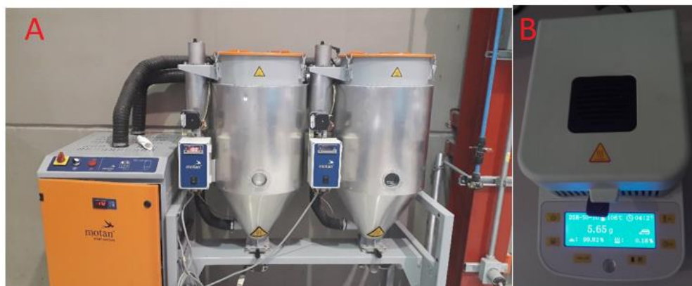
Figura 29 Equipos para deshumidificar (A) y para medir la humedad en el polímero (B)
