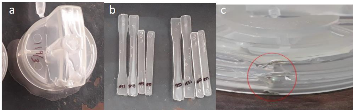
Figura 6 Algunos defectos en inyección de plásticos, rebabas (a), ráfagas (b) y efecto Diesel (c) 6
