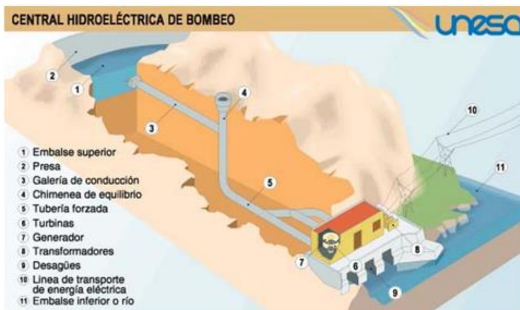
Figura 1.2. Central hidroeléctrica de bombeo.
