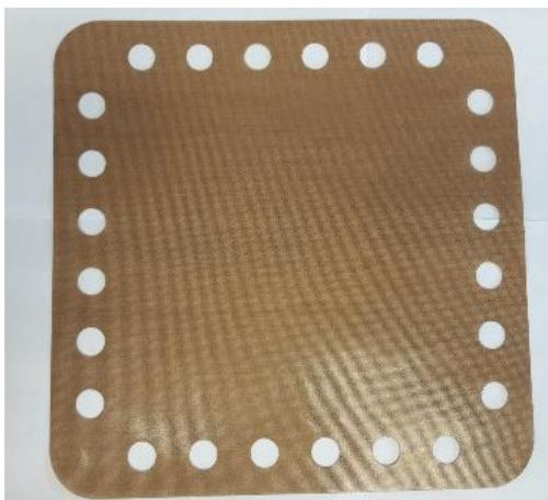
**Figura 2.8. Membrana de intercambio iónico de la marca comercial FUMATECH.**
