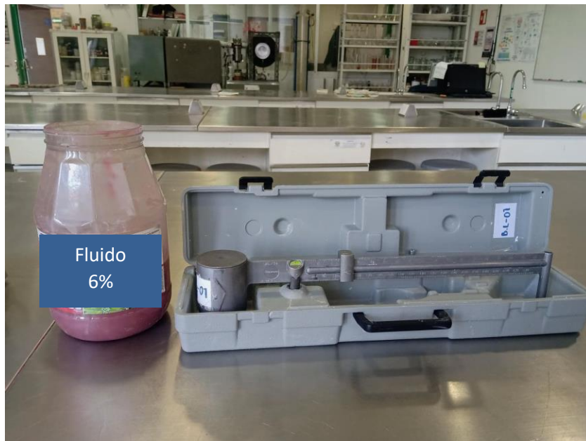
Figura 26. Medición de la densidad de la prueba 3. (Laboratorio de elementos de perforación, FI, UNAM, 2022)
