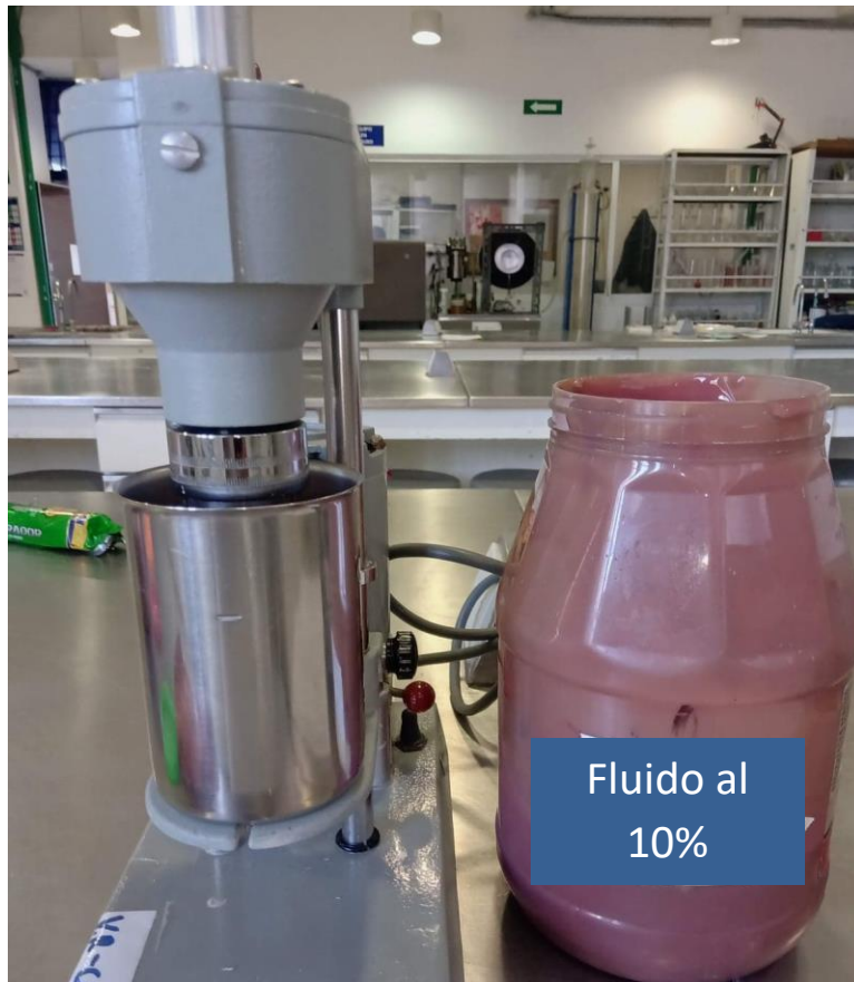
Figura 27. Reómetro usado para las mediciones de la reología. (Laboratorio de elementos de perforación, Jimena Pérez, 2022).
