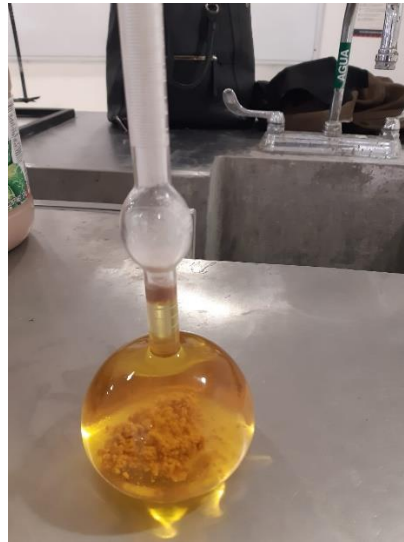
Figura 23. Prueba de densidad con el matraz de le' Chatelier (Laboratorio de elementos de perforación, FI, UNAM, 2022).
