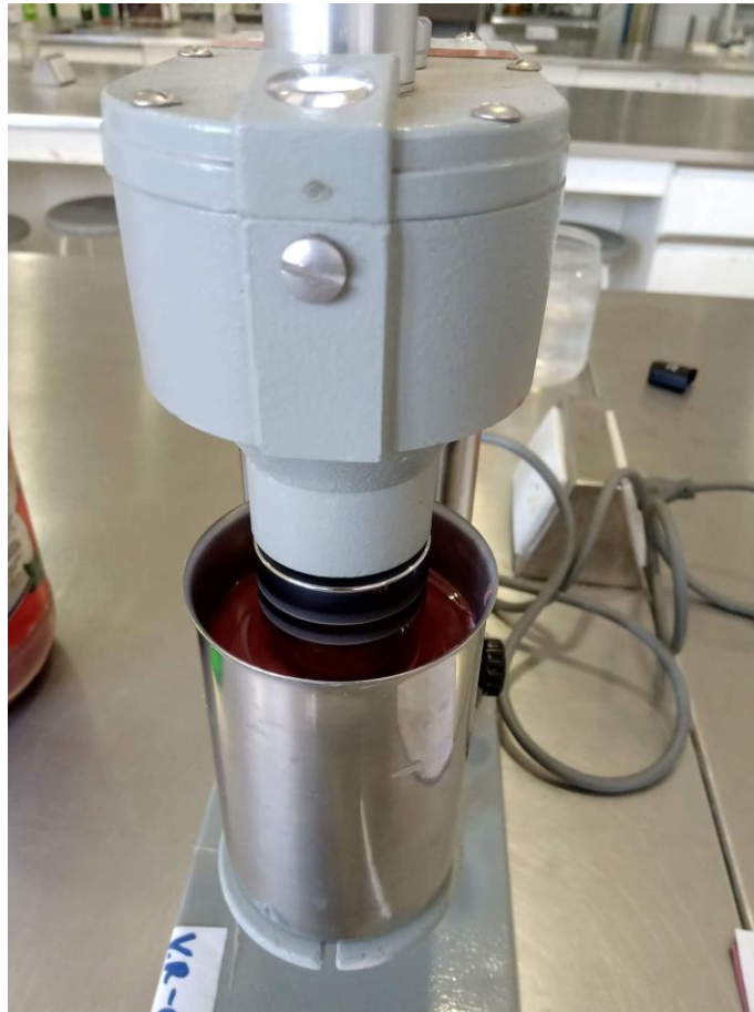
Figura 29. Medición de la reología de las pruebas y la toma de datos. (Laboratorio de elementos de perforación, Jimena Pérez, 2022).
