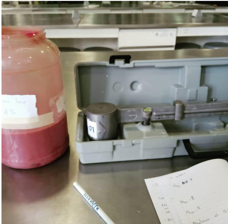
Figura 18. Medición de la densidad con ayuda de la balanza de lodos (Laboratorio de elementos de perforación, FI, UNAM, 2022).
