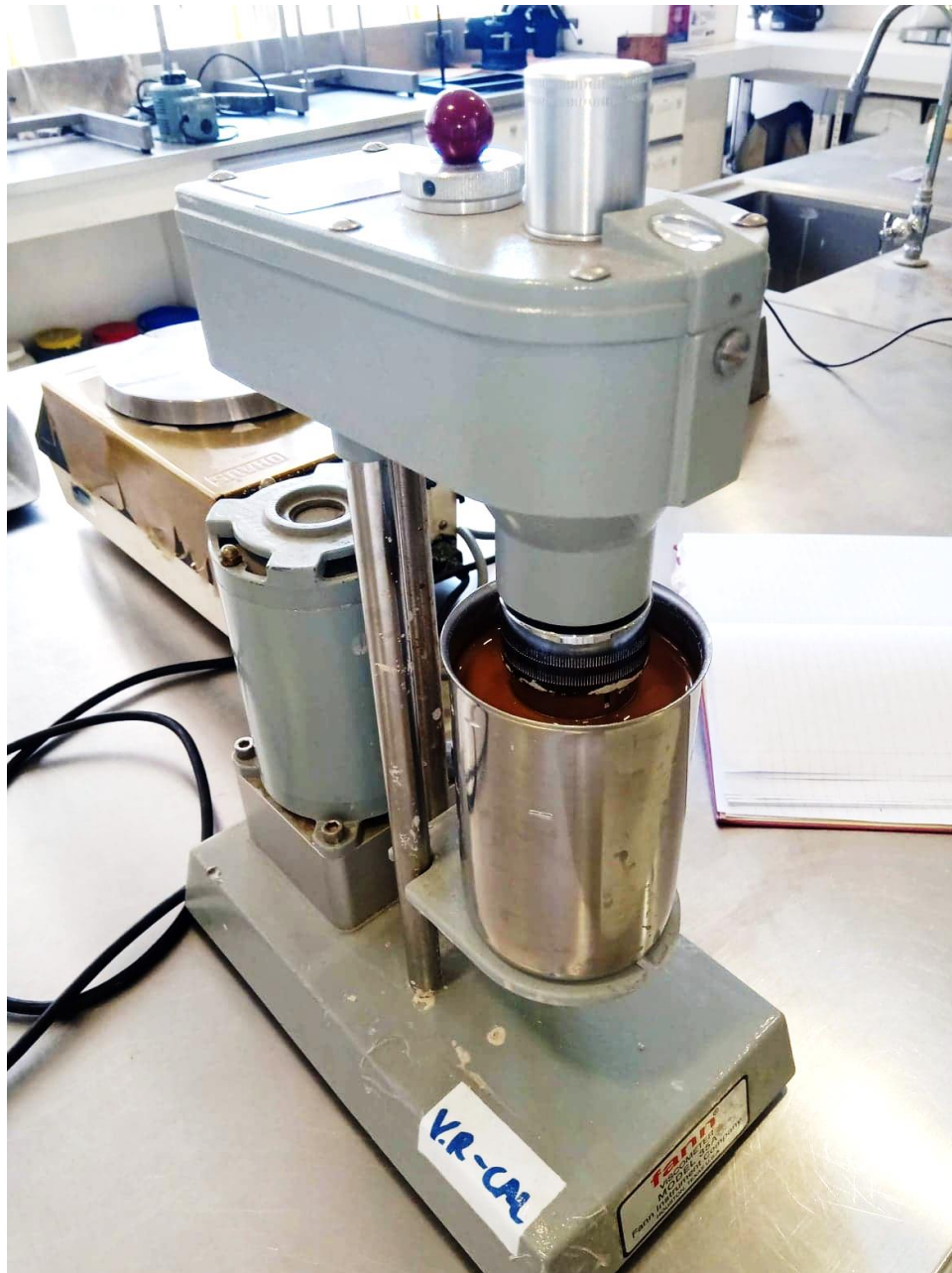
Figura 34. Medición de la reología, (Laboratorio de elementos de perforación, 2022)
