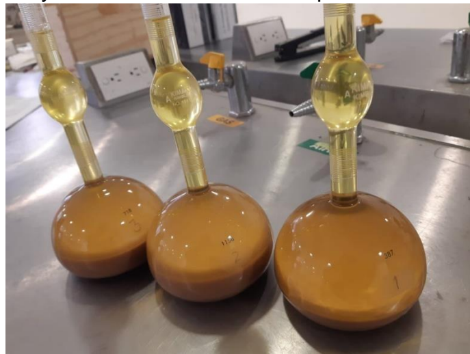
Figura 24. Prueba de densidad con el matraz de le' Chatelier (Laboratorio de elementos de perforación, FI, UNAM, 2022).
