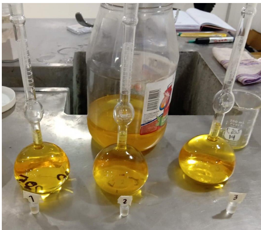
Figura 22. Prueba de densidad con el matraz de le' Chatelier. (Laboratorio de elementos de perforación, FI, UNAM, 2022).
