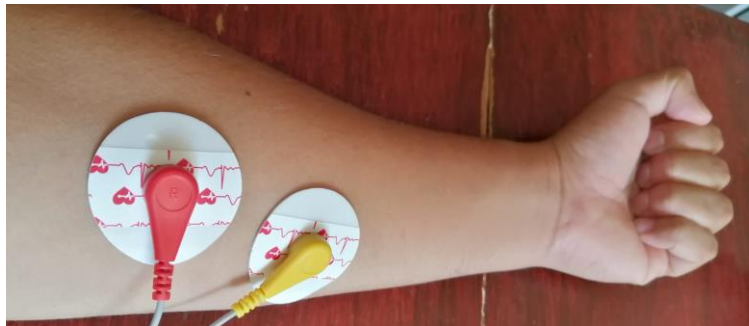
Fig. 2.5 Posición de electrodos; Dos electrodos posicionados en el antebrazo y un electrodo de referencia a tierra en el codo.
