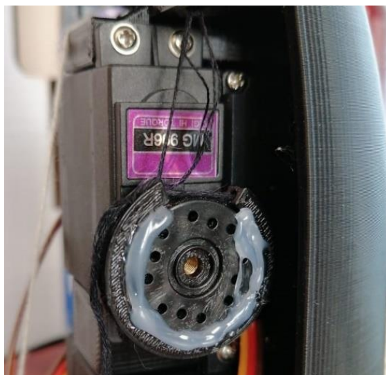
Fig. 2.14. Posición inicial de 0 grados. Cada servomotor tendrá esta configuración. El silicón ubicado en la polea sirve para tener un mejor agarre entre el servomotor y la pieza móvil.
