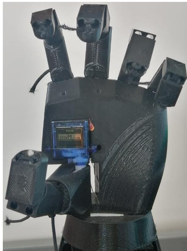
Fig. 3.20 Cierre de dedos sin generar una interrupción por medio de “Monitor Serie”.
