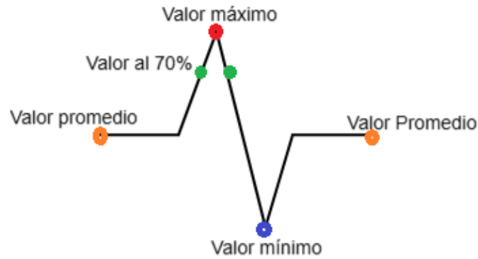
Fig. 2.10 Característica de la señal EMG . En color naranja se visualiza el valor promedio, en color verde se visualiza el 70 % del valor máximo, En rojo se visualiza el valor máximo y en azul el valor mínimo de un detector de picos.
