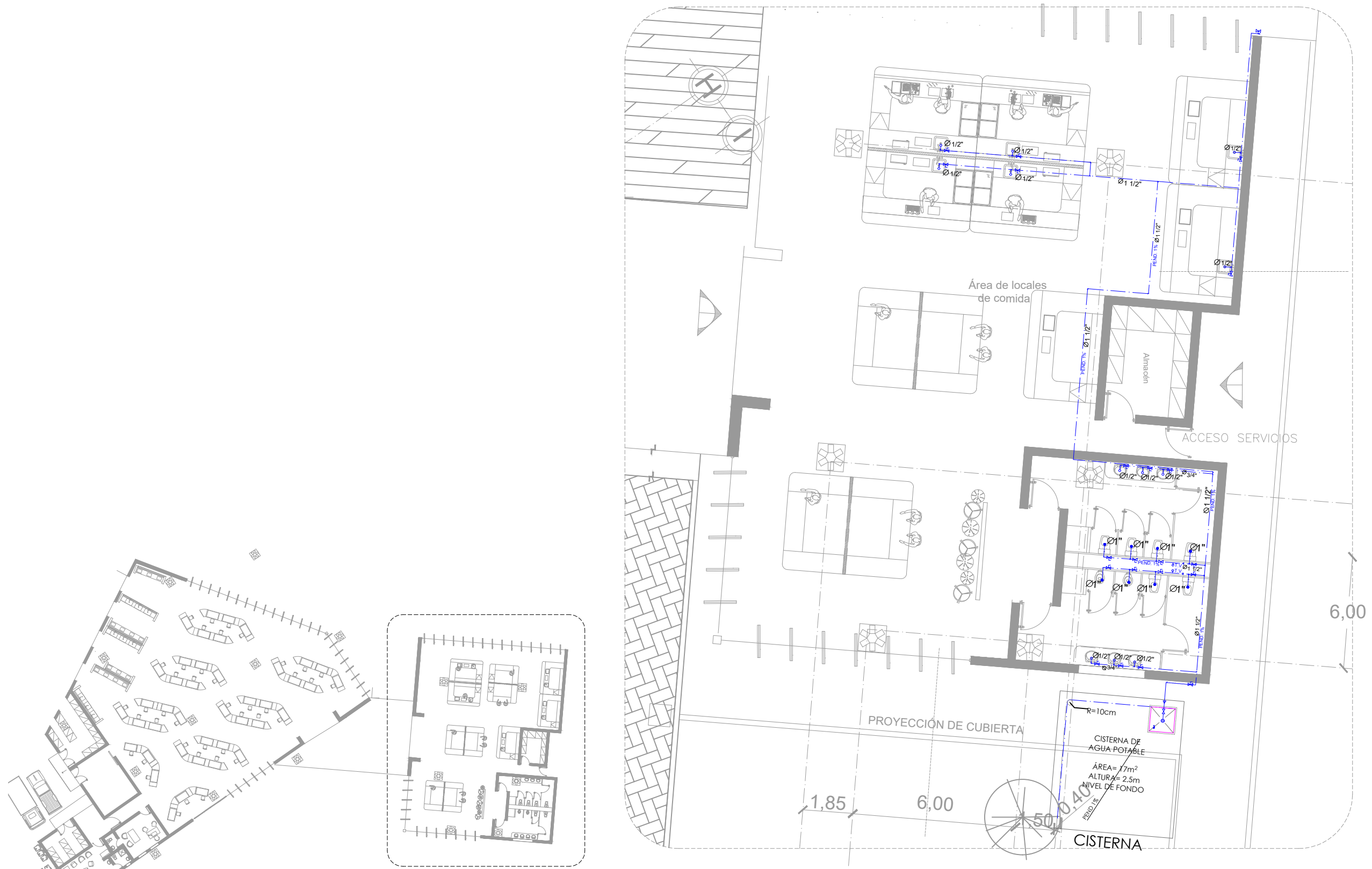
INSTALACIÓN HIDRÁULICA COMPONENTE 2 (ZOOM) ESC 1:150
