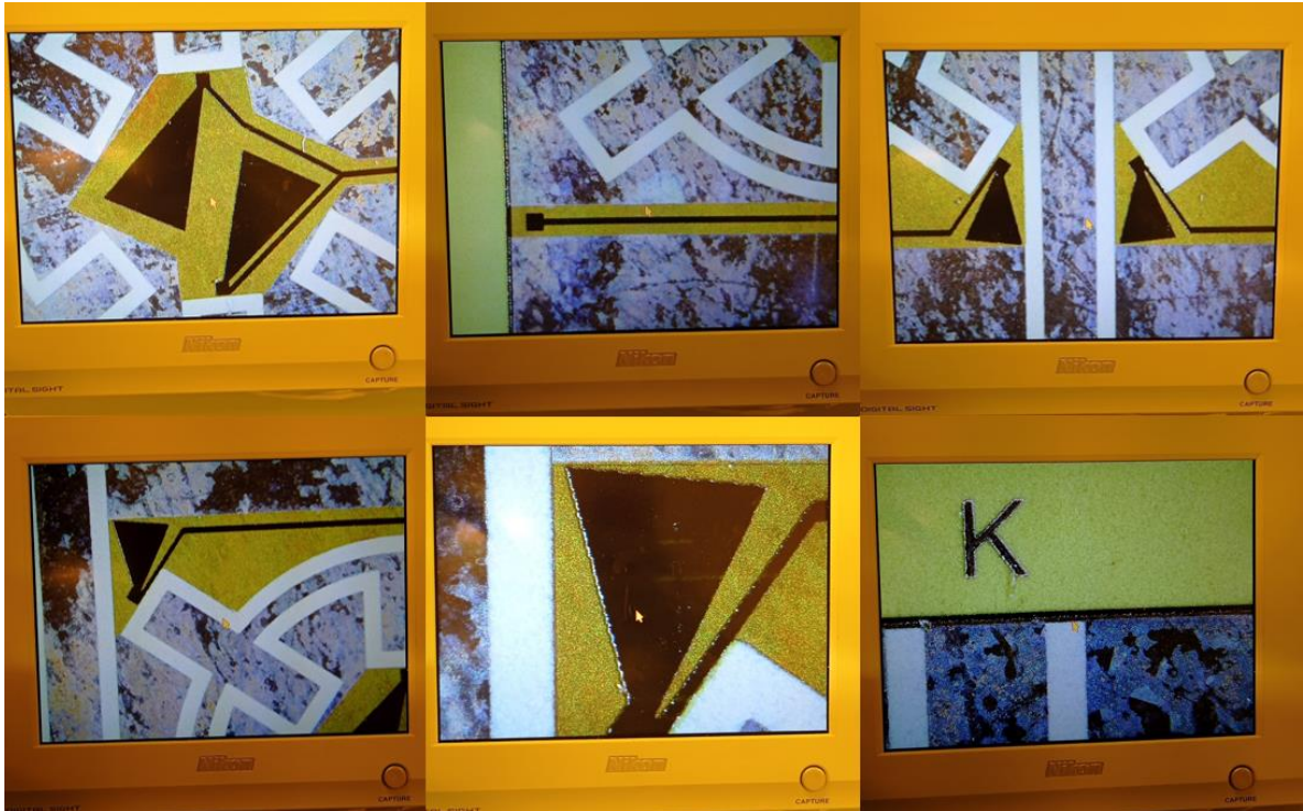
Figura 4. 19. Fotografías tomadas en el microscopio de la oblea una vez realizado el ataque de cobre.
