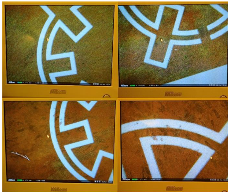
Figura 4. 9. Fotografías tomadas en el microscopio de la oblea una vez realizado el grabado de cobre.
