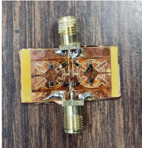
Figura 4. 22. Soldadura de los conectores SMA en los puertos del circuito.
