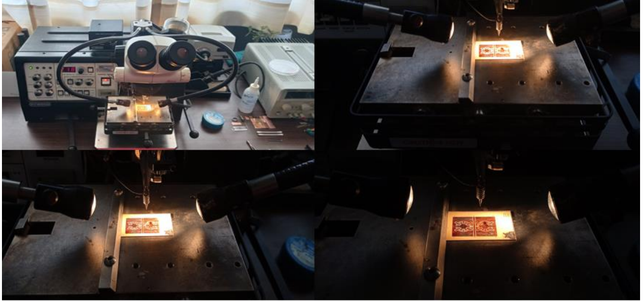
Figura 4. 20. Proceso de sodado de los diodos varactores en la microsoldadora.
