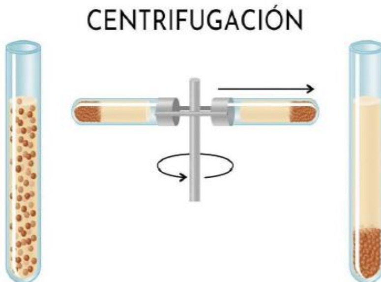
Figura III.14 Proceso de centrifugado
