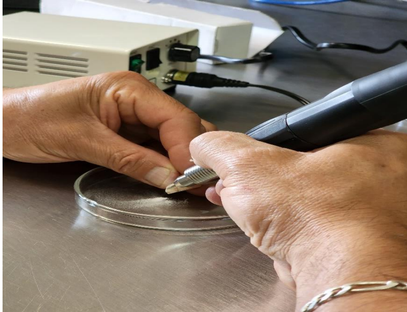
Figura III.10. Obtención de polvo de esmalte usando la pieza de mano.
