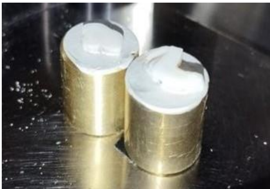
Figura III.9. Muestra transversal(izquierda) y muestra longitudinal preparadas para ser observadas en el microscopio electrónico de barrido (SEM).
