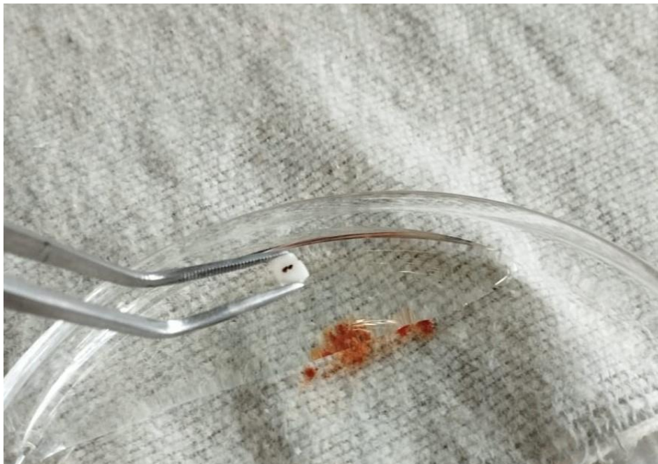
Figura III.8 Ataque químico a la muestra para revelar su estructura
