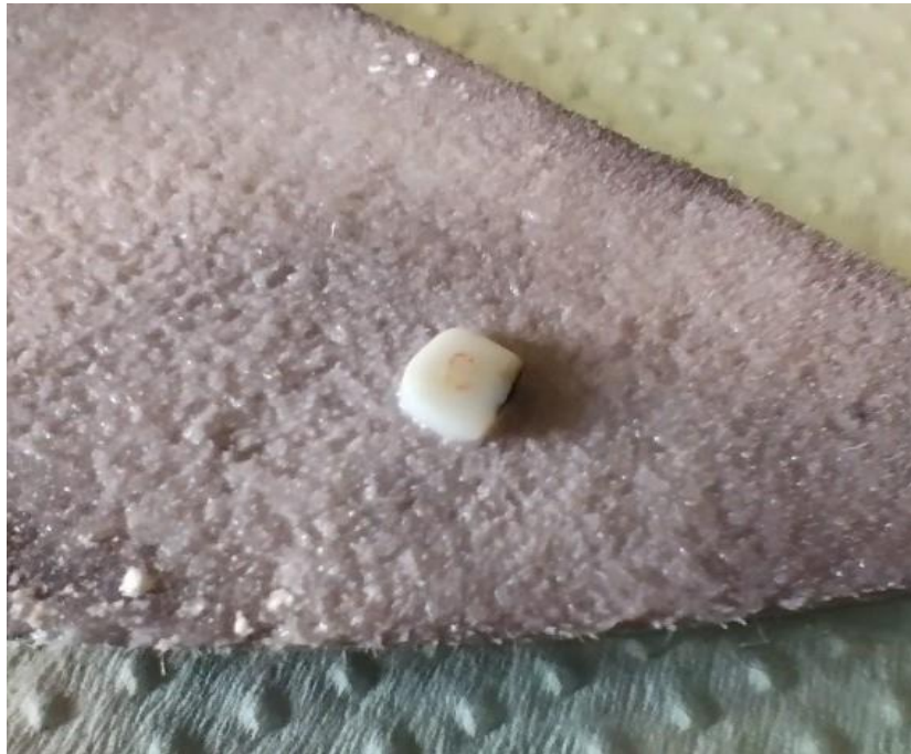
Figura III.7. Pulido espejo usando alúminas con un tamaño de grano 1\ \mu\text{m} y paño mojado
