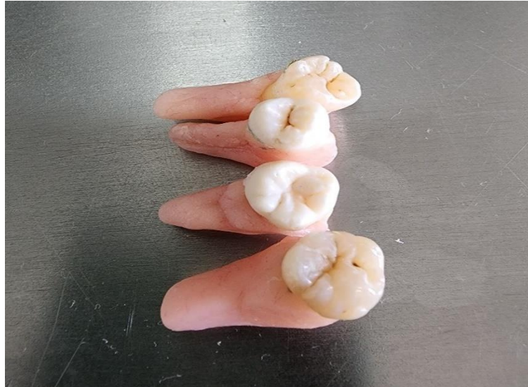
Figura III.3. Piezas dentales preparadas con la Mezcla del monómero NICTONE y polímero Quarz R2V
