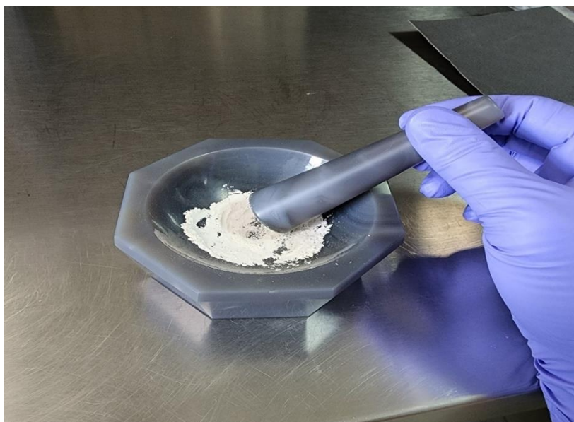
Figura III.12. Proceso de trituración en el mortero de ágata
