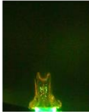
Figura 30. Visualización con tintura del vórtice toroidal en el medio estratificado. Se muestra la trayectoria del vórtice y en la parte superior se indica el tiempo que transcurrió desde su formación cuando t = 0 . Se observa la evolución del vórtice toroidal y el colapso de este. Imágenes obtenidas con la cámara réflex.
