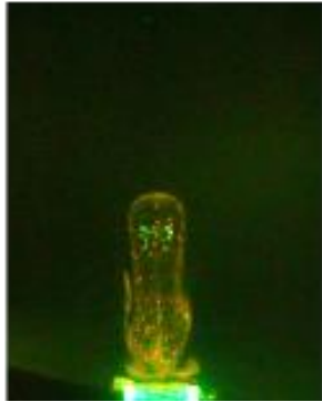
Figura 30. Visualización con tintura del vórtice toroidal en el medio estratificado. Se muestra la trayectoria del vórtice y en la parte superior se indica el tiempo que transcurrió desde su formación cuando t = 0 . Se observa la evolución del vórtice toroidal y el colapso de este. Imágenes obtenidas con la cámara réflex.
