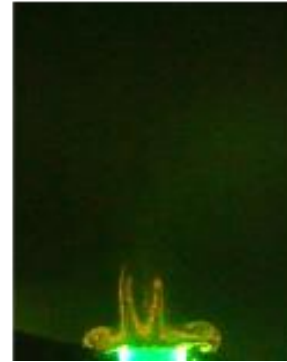
Figura 30. Visualización con tintura del vórtice toroidal en el medio estratificado. Se muestra la trayectoria del vórtice y en la parte superior se indica el tiempo que transcurrió desde su formación cuando t = 0 . Se observa la evolución del vórtice toroidal y el colapso de este. Imágenes obtenidas con la cámara réflex.
