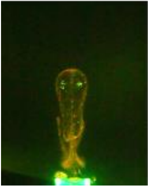
Figura 30. Visualización con tintura del vórtice toroidal en el medio estratificado. Se muestra la trayectoria del vórtice y en la parte superior se indica el tiempo que transcurrió desde su formación cuando t = 0 . Se observa la evolución del vórtice toroidal y el colapso de este. Imágenes obtenidas con la cámara réflex.
