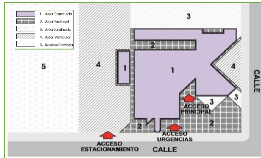
Imagen 47. Plano de tipo de unidad de 216 camas censables. Fuente. Criterios normativos de proyecto arquitectónico para imagen institucional en áreas exteriores 2003
